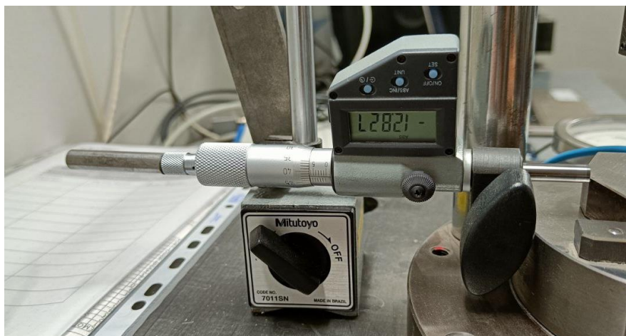
Figura 72. Fotografia del micrometro digitale RUPAC utilizzato per il posizionamento radiale del contropattino
