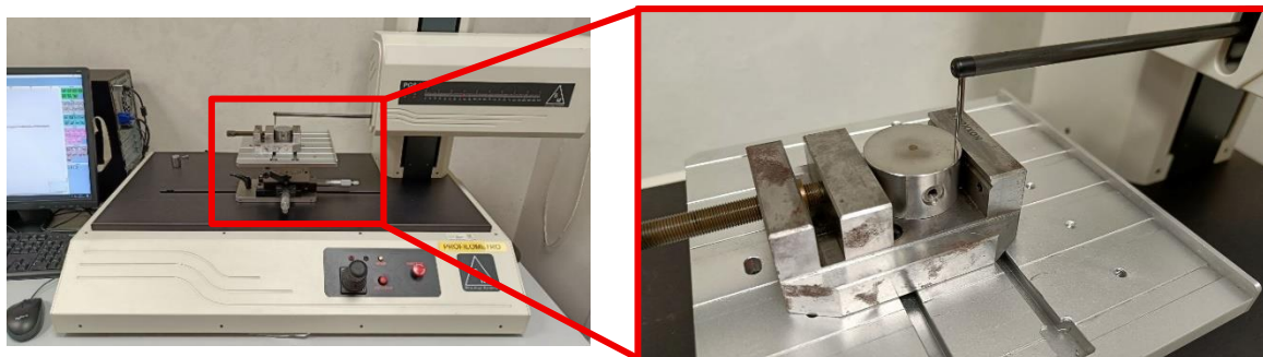
Figura 50. Profilometro utilizzato per la misurazione delle superfici attive dei cuscinetti
