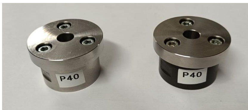
Figura 47. Fotografia di due cuscinetti completi di coperchio: versione in acciaio a sinistra e in alluminio con anodizzazione dura a destra.
