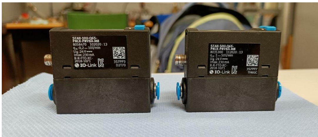
Figura 664. Flussimetri utilizzati per la misura dei consumi d'aria: a sinistra il modello per portate ridotte (0.2-10 l/min) e a destra quello per portate elevate (1-50 l/min)
