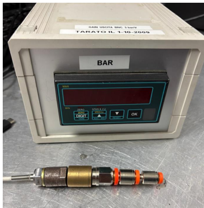
Figura 68. Sensore di pressione (in basso) e il relativo amplificatore di segnale (in alto)
