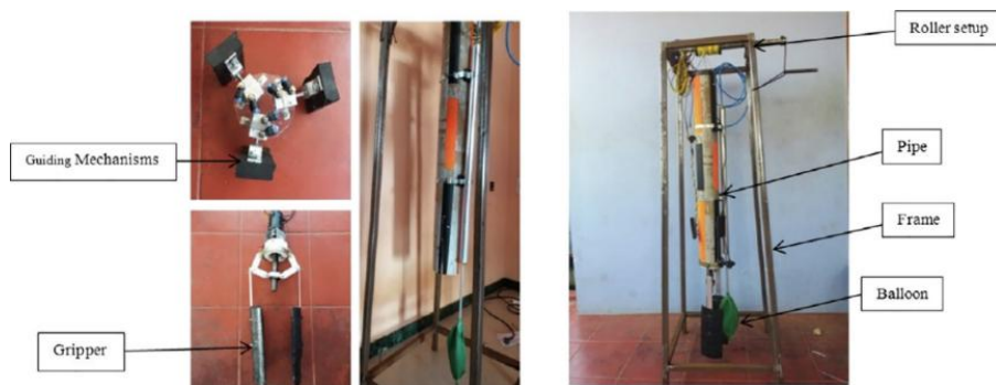
Figura 1.7: Sistema di salvataggio robotico di Dhiyaneswaran et al. [4]
