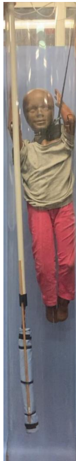
Figura 5.17: Posizionamento del dispositivo nel condotto in plexiglass
