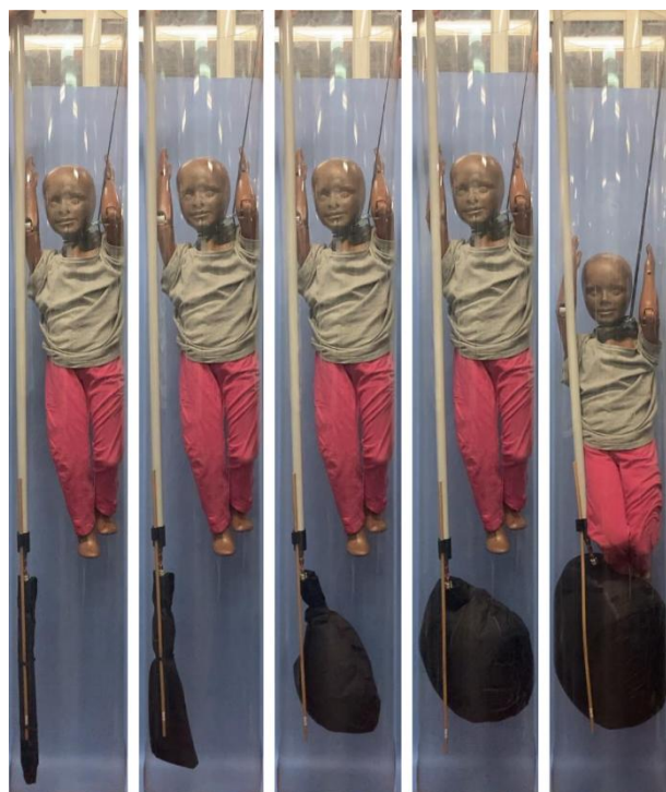
Figura 5.15: Sequenza di sgancio elastici con prototipo in nylon-TPU
