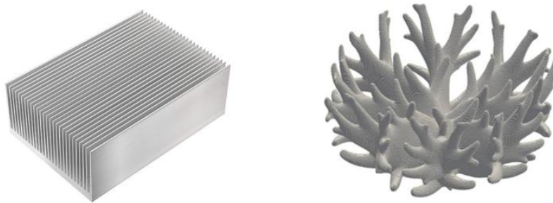
Figura 6: Dissipatore tradizionale ad alette parallele (plate-fin, a sinistra) e dissipatore topologicamente ottimizzato per convezione naturale (esempio accademico, a destra) [18]
