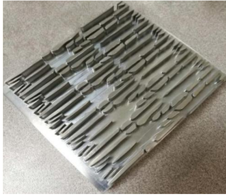
Figura 7 [19] : Dissipatore topologicamente ottimizzato per convezione forzata
