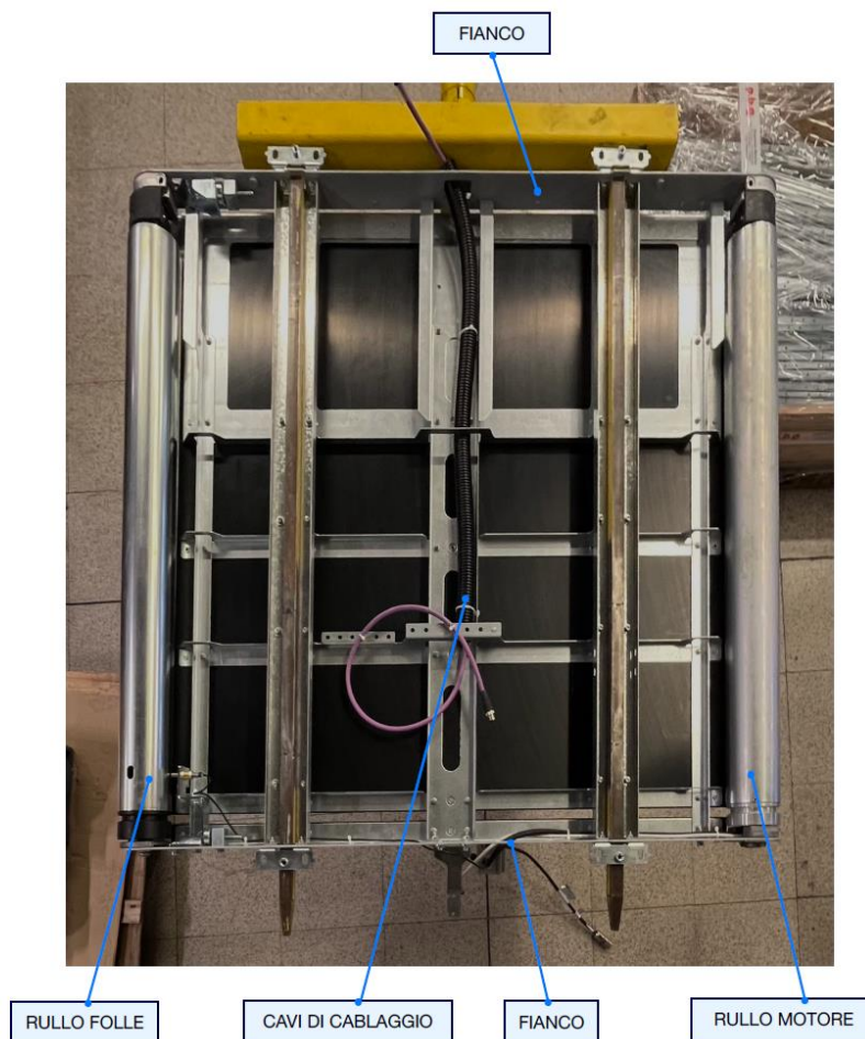
Figura 4.1 Cella di smistamento aeroportuale, priva di nastro e flappa, Leonardo S.p.A.
