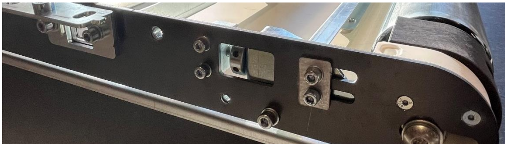
Figura 9.1 Sistema di tensionamento del nastro montato su uno dei fianchi della cella di smistamento
