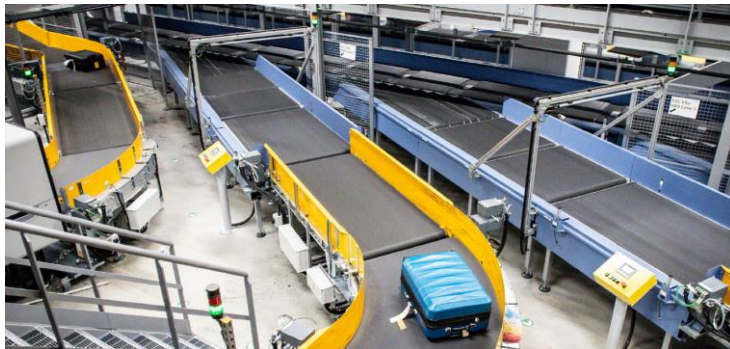
Figura 2.2.6 Linee di induzione per il caricamento dei bagagli aeroportuali sul sorter principale, Leonardo S.p.A. [7]
