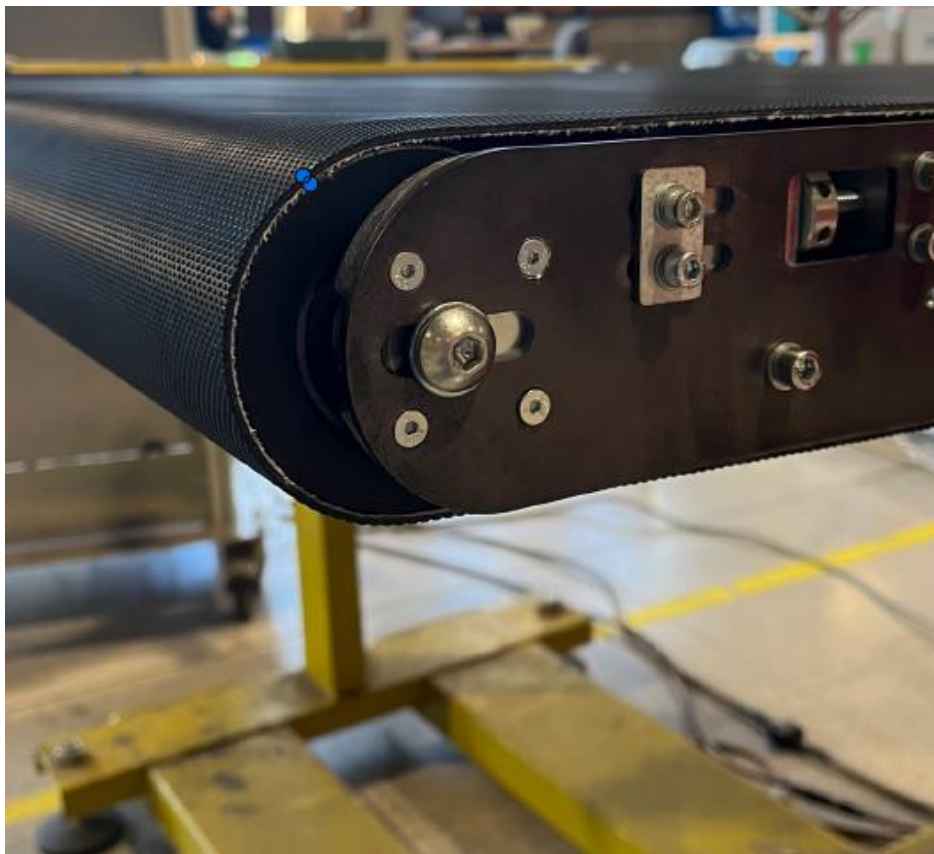
Figura 9.2 Illustrazione dei marker da eseguire sul nastro e sul rullo motore per l'esecuzione della prova di slittamento
