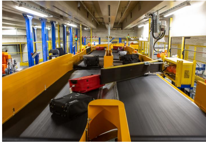
Figura 2.2.5 Nastro trasportatore dotato di un deviatore orizzontale, Leonardo S.p.A. [7]
