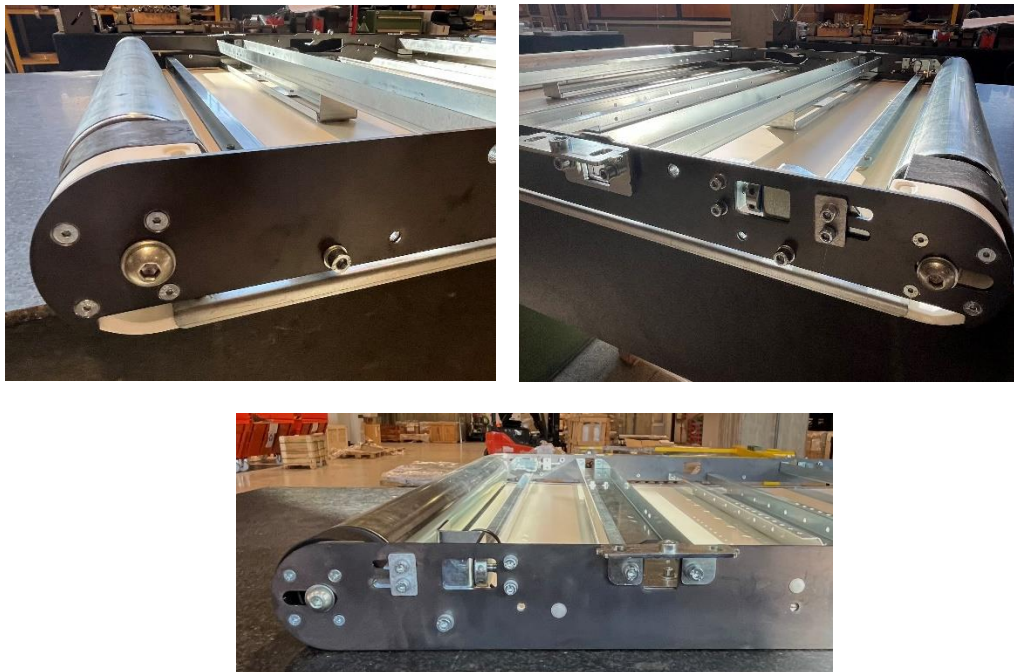
Figura 8.5 Focus sui fianchi rimodellati per assicurare il montaggio del nuovo gruppo pianale-telaio
