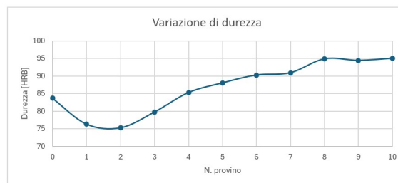
Figura 5.9: Andamento della durezza in funzione del numero di provino. Il provino 0 è costituito esclusivamente da acciaio, mentre il 10 esclusivamente da Inconel.
