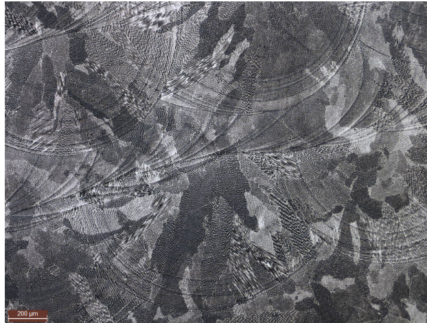
Figura 4.11: Risultato dell'attacco acido su un provino in acciaio osservato sulla sezione x-z.
