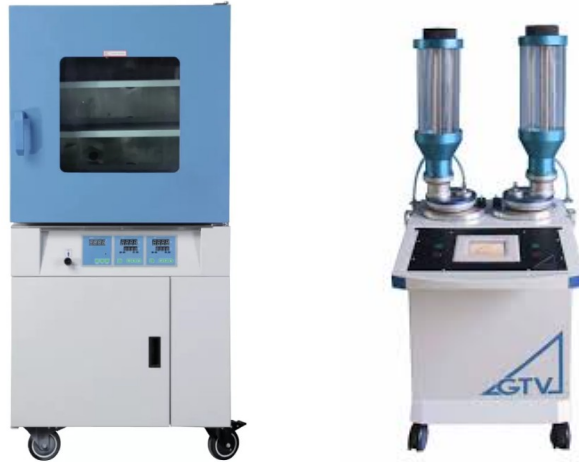
Figura 4.2: Preparazione e alimentazione delle polveri metalliche: (a) forno per l'essiccazione delle polveri [39]; (b) powder feeder GTV utilizzato per l'alimentazione del materiale [38].
