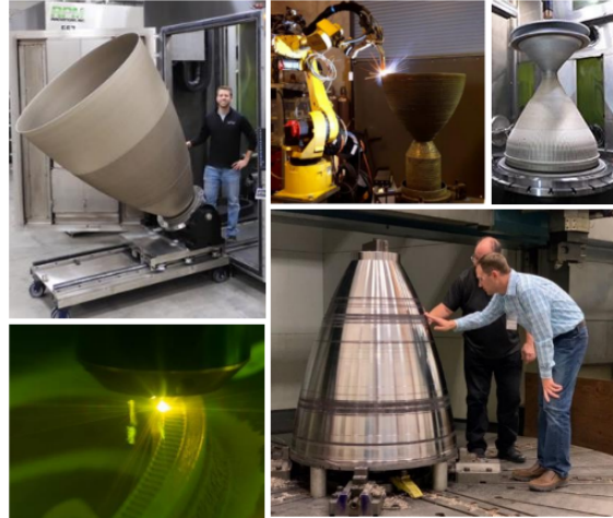
Figura 2.4: Ugello su larga scala realizzato per applicazioni aerospaziali. Ripubblicato da [15] , con il permesso della NASA.
