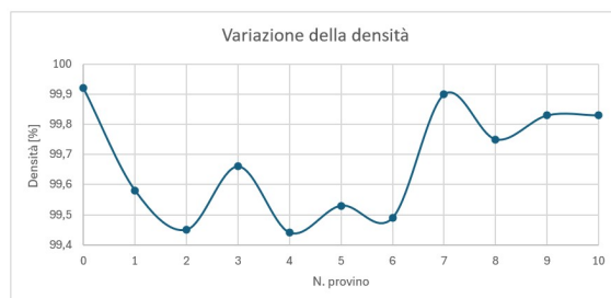
Figura 5.10: Andamento della densità in funzione del numero di provino. Il provino 0 è costituito esclusivamente da acciaio, mentre il 10 esclusivamente da Inconel.
