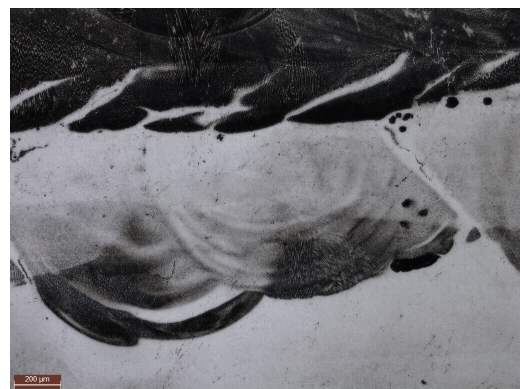
(d) Attacco acido alla zona di transizione – provino 5 .
