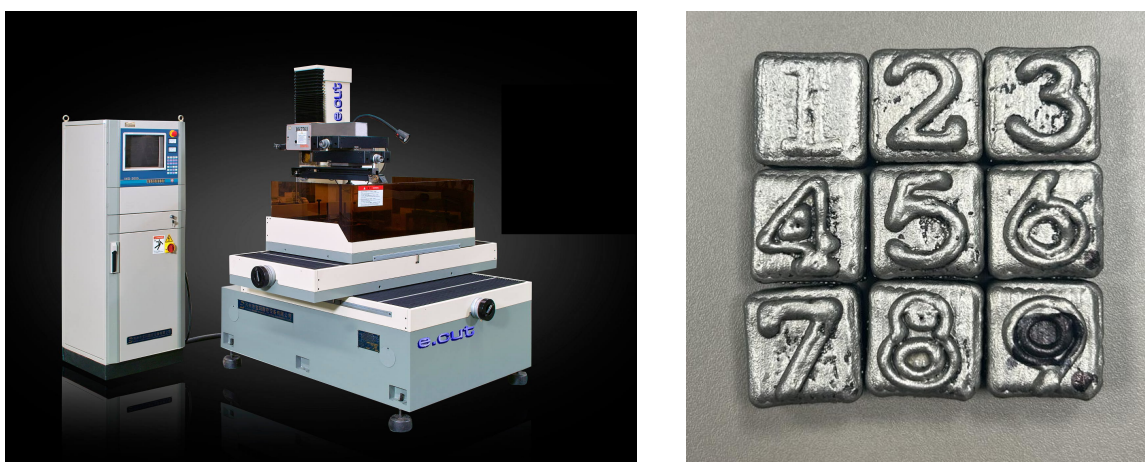
Figura 4.5: Taglio dei provini: (a) sistema E-cut per la separazione dei campioni [42]; (b) provini ricavati dalla piastra dopo l'operazione di taglio.
