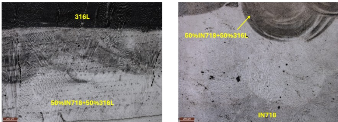
Figura 5.25: Attacco chimico su interfaccia superiore e inferiore del provino 5 (sez. x-z, zoom 5×).
