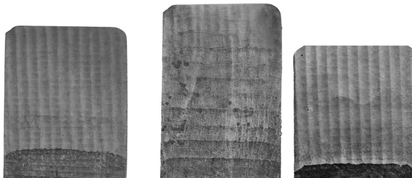
Figura 5.31: Micrografia ricostituita mediante tecnica di stitching della sez. x-z dei provini 1 e 2 dopo attacco chimico.
