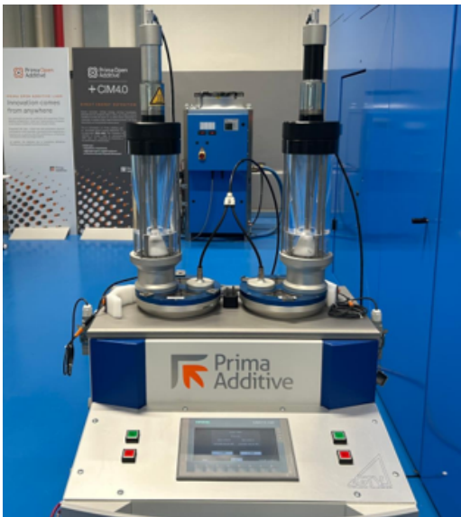
Figura 4.21: Configurazione del sistema di alimentazione multi-materiale.
