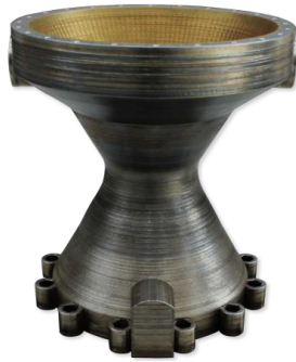
Figura 3.4: Ugello di combustione a 3 tonnellate destinato alle prove di verifica di un sistema di propulsione, realizzato con struttura bimetallica [27].
