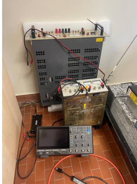
Figura 29: Amplificatori di corrente e oscilloscopio
