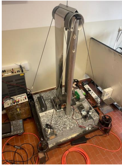
Figure 28: Pendolo costruito per ridurre le vibrazioni
