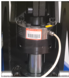
(a) Cella di carico Metior modello CVC da 50 kN installata sul banco prova.
