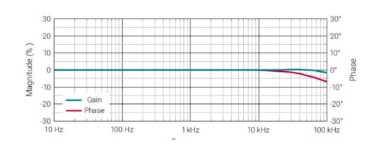
(a) Diagramma di Bode del trasduttore DaniSense DS50UB-10V
