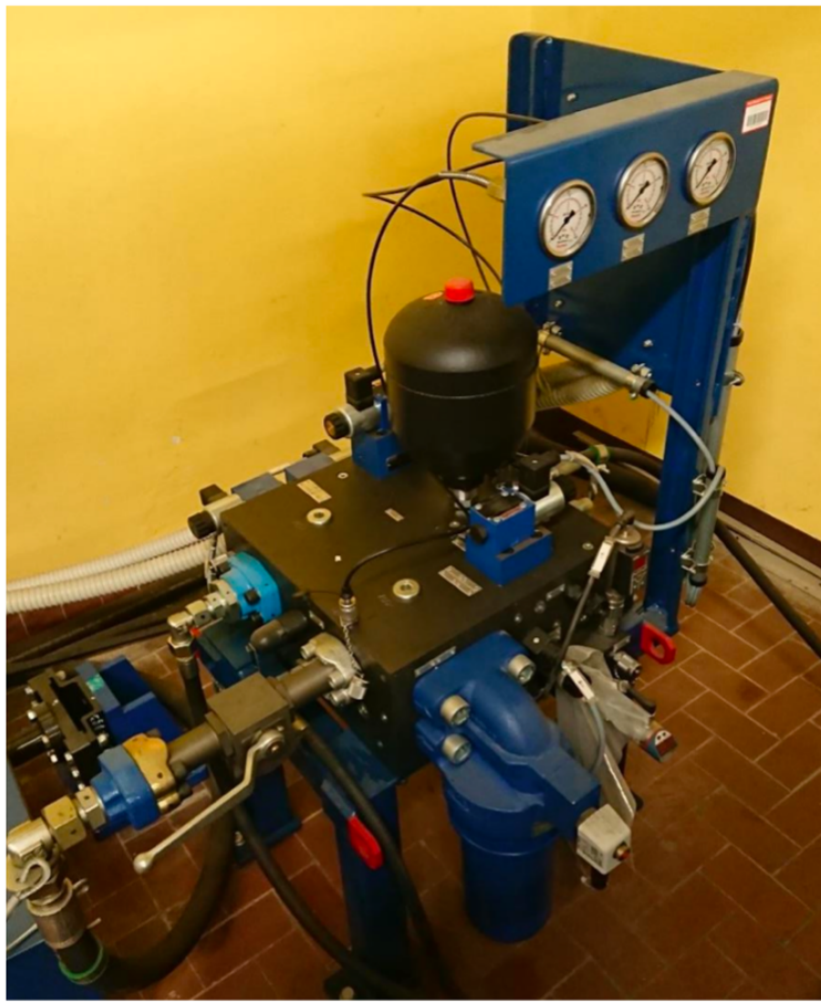
Figura 3.5: Manifold per la gestione della potenza idraulica in alimentazione al banco prova.
