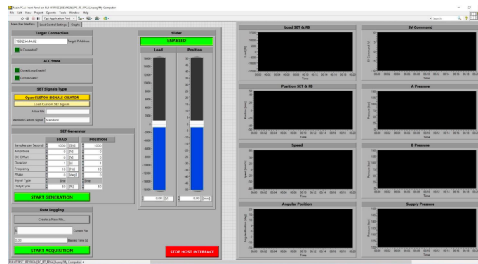
Figura 3.27: Interfaccia software su PC per il controllo del banco prova: generazione dei segnali di riferimento, monitoraggio in tempo reale delle grandezze principali e gestione dell'acquisizione dati.
