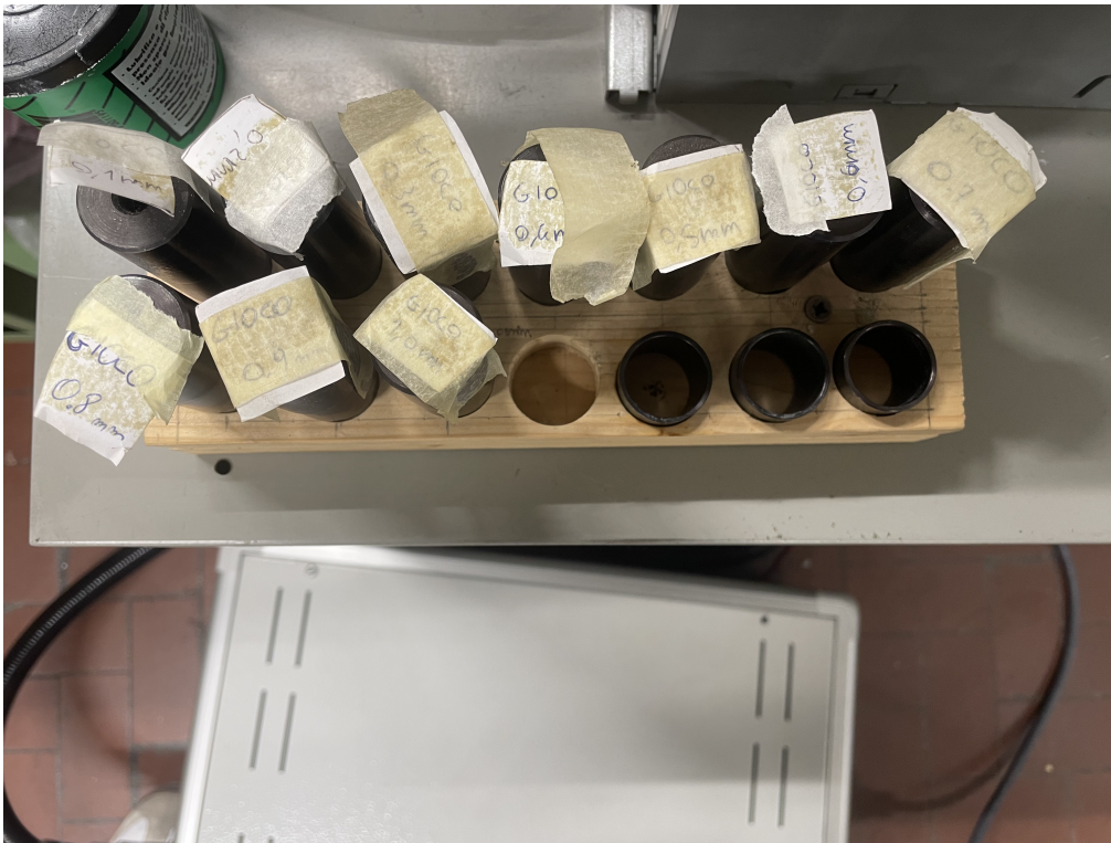
Figura 5.1: Perni a diverso diametro utilizzati per l'introduzione controllata del gioco nel rod-end.
