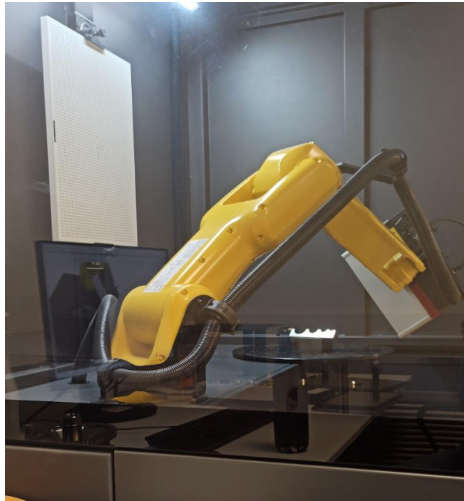
Figura 1. Sistema di Misura a Coordinate (CMS), impiegato per l’acquisizione dei dati degli artefatti.
