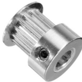
Figura 6.3: Puleggia dentata 16 denti in alluminio, diametro esterno 13 mm, diametro foro 5 mm, larghezza cinghia max. 7 mm, larghezza totale 14 mm [28]
