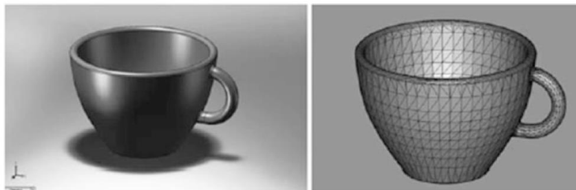
Figura 1.4: Conversione del modello CAD nel formato STL [6]
