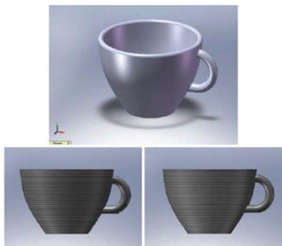
Figura 1.2: Modello CAD di una tazza con immagini aggiuntive che illustrano l'influenza di layer di diverso spessore sulla costruzione [6]
