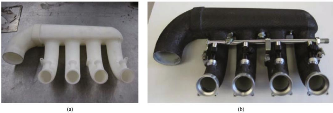
Figura 1.1: (a) Assemblaggio finale di un collettore di aspirazione realizzato tramite stampante FDM, (b) Sistema di aspirazione completato dopo processi di finitura e l'assemblaggio finale di sensori e supporti [5]
