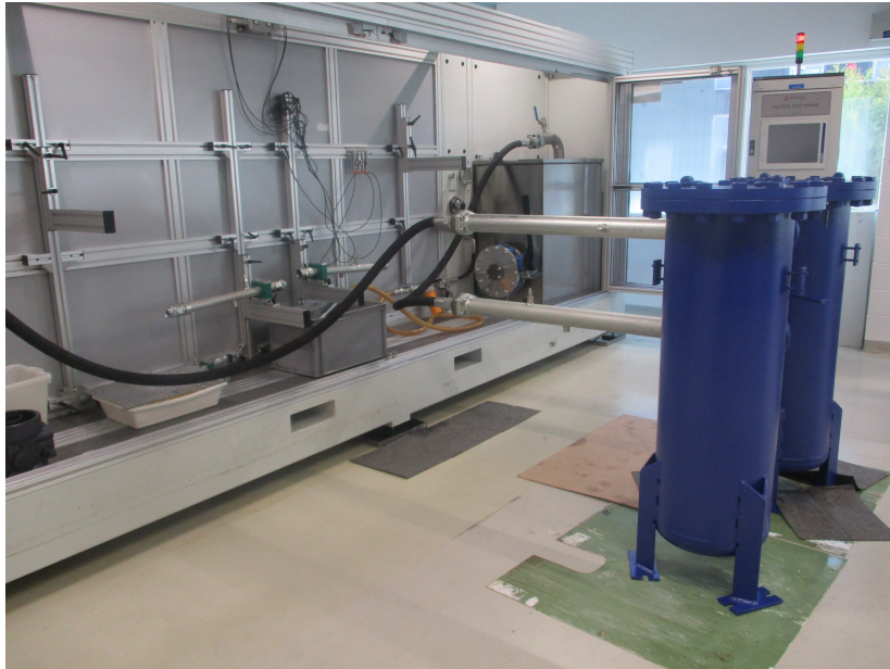
Fig. 8: Banco prova e filtro ad alta portata duplex
