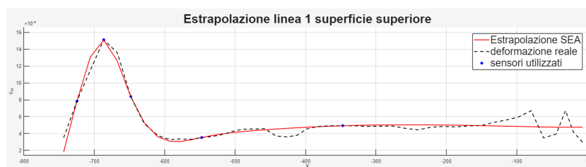
Figura 4.28: Estrapolazione della prima linea superiore utilizzando la configurazione ottimale di sensori.
