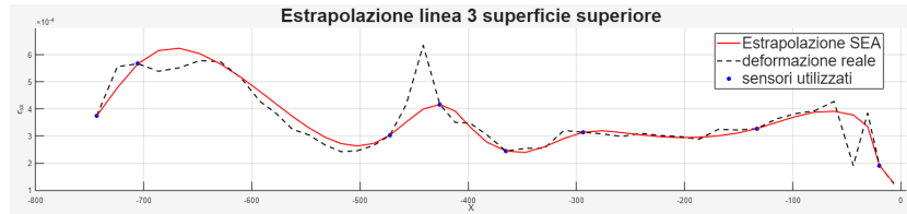
Figura 4.30: Estrapolazione della terza linea superiore utilizzando la configurazione ottimale di sensori.
