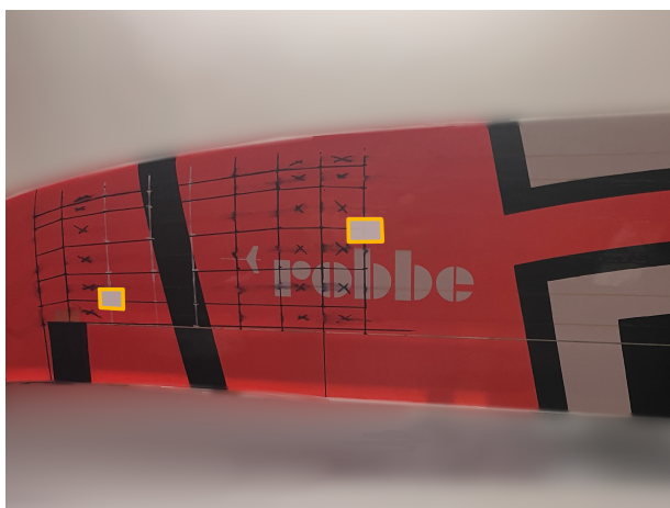
Figura 4.7: Superficie inferiore con superfici riflettenti (evidenziate in giallo)
