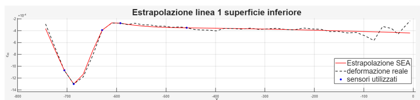
Figura 4.31: Estrapolazione della prima linea inferiore utilizzando la configurazione ottimale di sensori.
