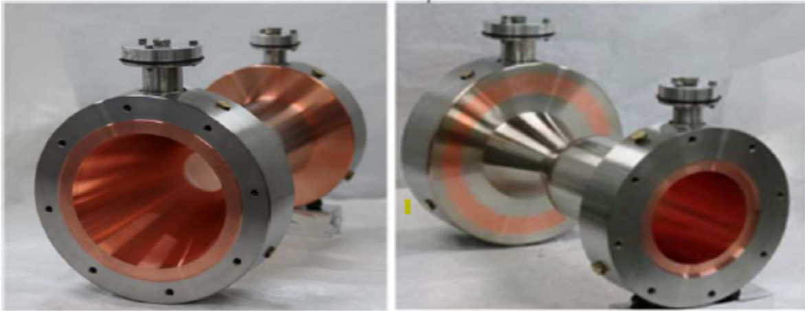
Figura 1.5: Camera di combustione della prima unità del dimostratore HYPROB DEMO (DEMO-0A) [16]
