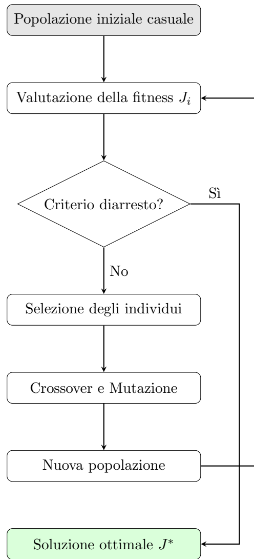
Figura 16: Diagramma di flusso dell’algoritmo genetico.
