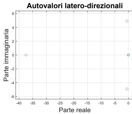
Figura 5.9: Autovalori latero-direzionali della configurazione V1_1 (OpenVSP, livello del mare).
