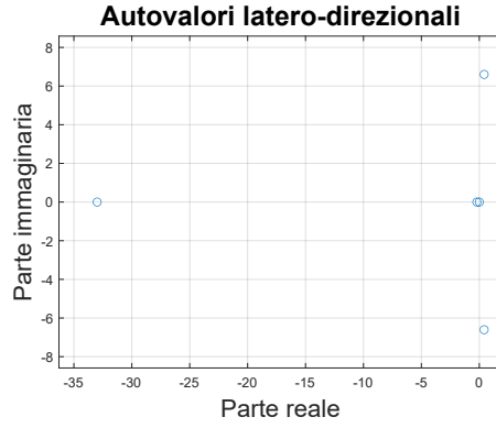
Figura 5.23: Autovalori latero-direzionali della configurazione V1_3 (OpenVSP, livello del mare).
