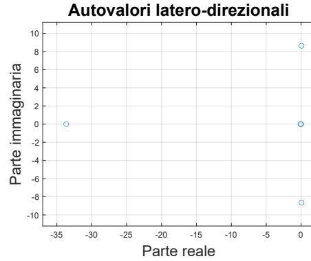
Figura 5.28: Autovalori latero-direzionali della configurazione V1_4 (OpenVSP, livello del mare).
