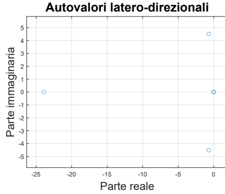
Figura 5.4: Autovalori latero-direzionali della configurazione V1 (OpenVSP, livello del mare).
