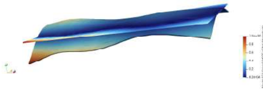
Figura B.67: Modo 7, 240.702 Hz
