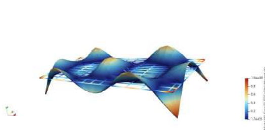
Figura B.95: Modo 15, 515.066 Hz
