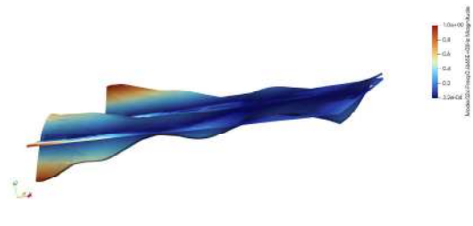
Figura B.78: Modo 18, 666.471 Hz
