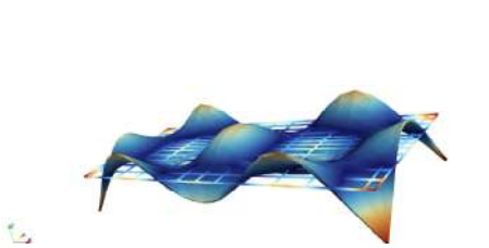
Figura B.15: Modo 15, 516.385 Hz
