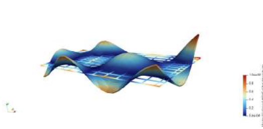
Figura B.53: Modo 13, 402.407 Hz
