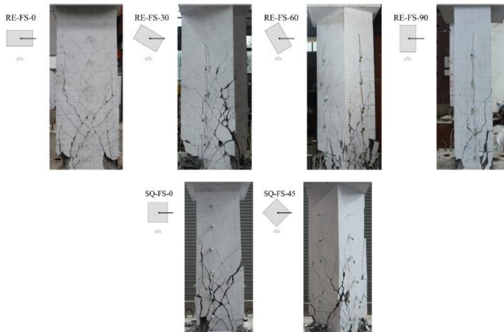
Figura 15: Immagini delle colonne in calcestruzzo armato (CA) al termine della prova (lo schizzo a sinistra di ciascuna immagine riporta il nome del provino, mentre la freccia e l'indicatore evidenziano rispettivamente la condizione di carico e il punto di ripresa fotografica).
