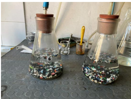
Figura 3.3 Deaerazione e quartatura delle plastiche MEG
