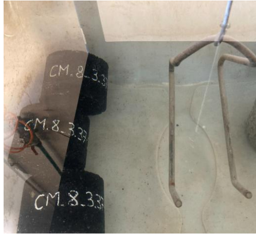
Figura 3.11 Immersione in acqua dei provini per determinazione della densità apparente
