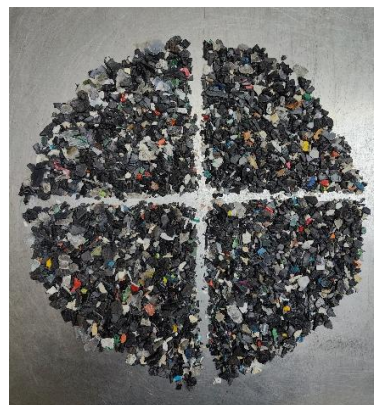
Figura 3.3 Deaerazione e quartatura delle plastiche MEG
