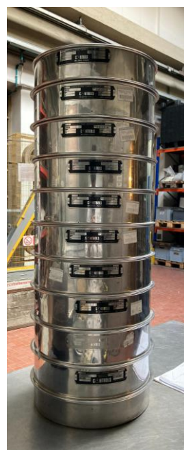
Figura 3.2 Colonna di setacci utilizzata nella prova di setacciatura
