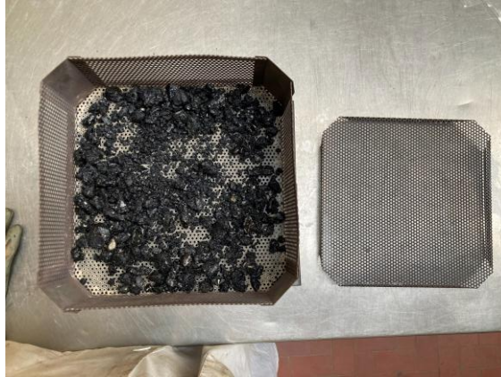
Figura 3.12 Cestello per prova di ignizione con materiale all'interno
