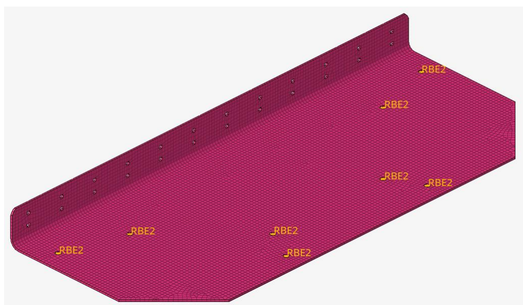
Figura 58-Sostegno meshato e vincolato
