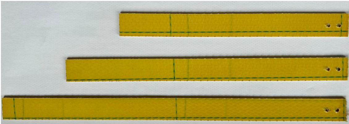
Figura 59-Provini di lunghezze 200 mm, 250 mm e 310 mm in materiale composito F155K285 HexPly parte anteriore
