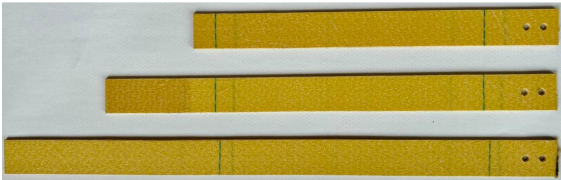
Figura 60-Provini di lunghezze 200 mm, 250 mm e 310 mm in materiale composito F155K285 HexPly parte posteriore
