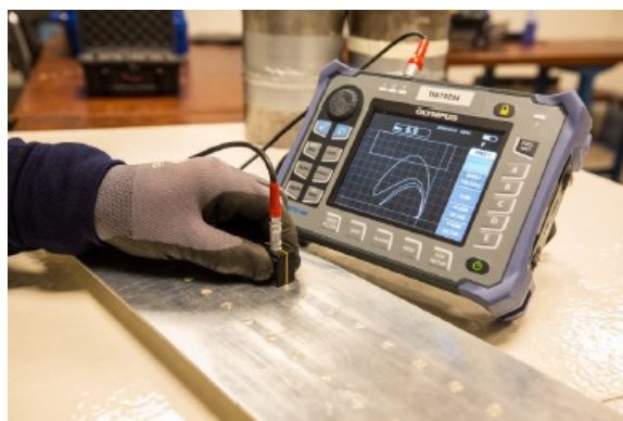
Figura 6.6: Esempio di controllo con eddy current
