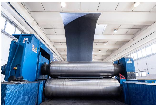
Figura 6.2: Esempio di calandratura di lamiera 1
