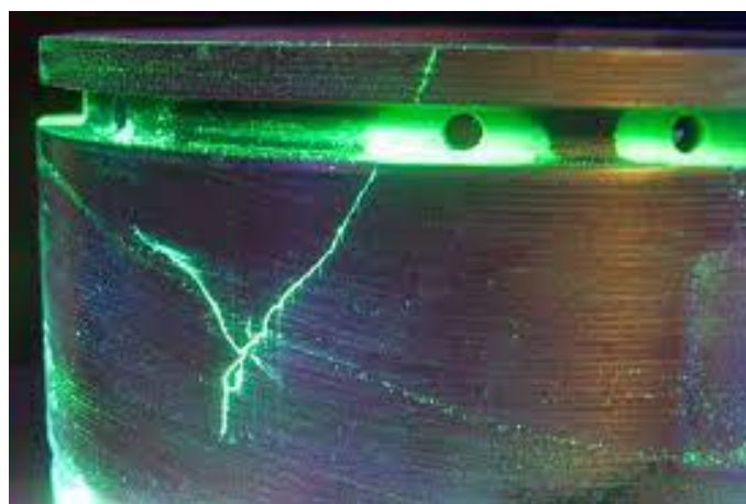
Figura 6.5: Esempio di utilizzo dei liquidi penetranti
