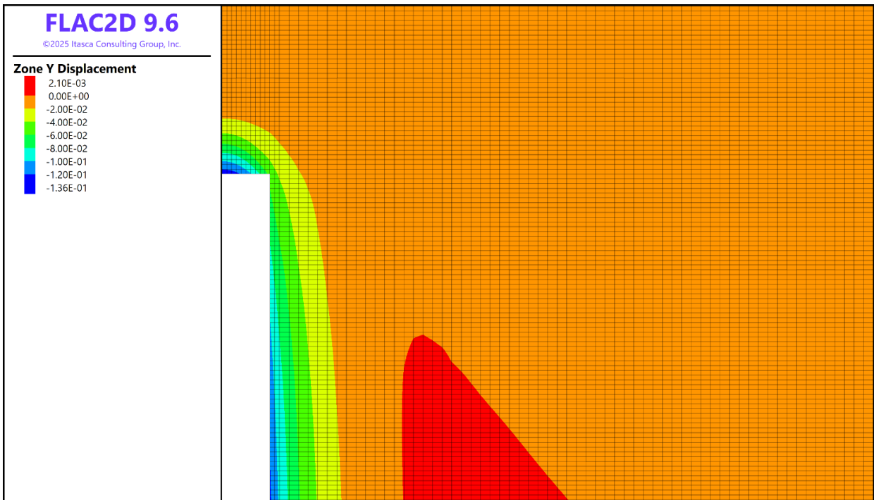
Figura 6.18: Spostamento lungo Y: Estrusione (unità di misura in metri [m])
