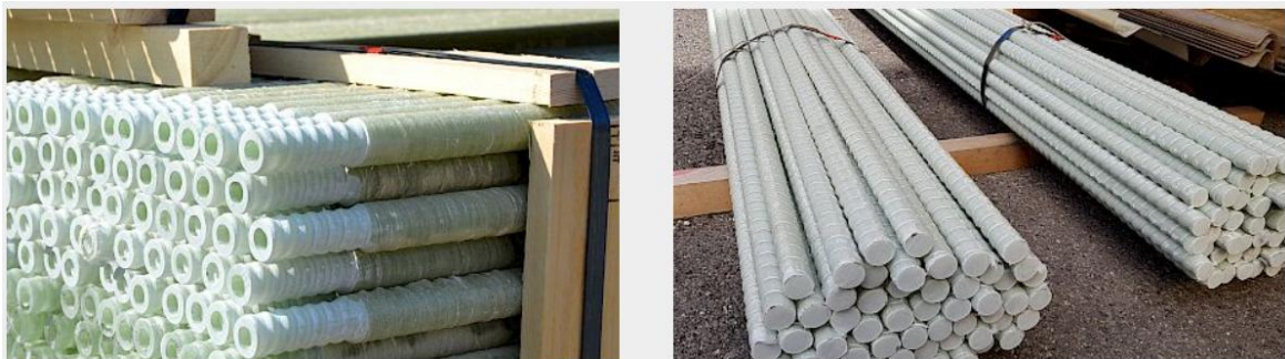
Figura 1.12: Tubi e barre in vetroresina per il rinforzo del fronte
