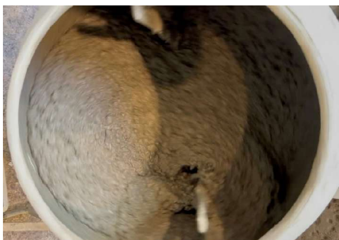
Figura 4-1: produzione dei campioni tramite miscelazione dei componenti del calcestruzzo in betoniera
