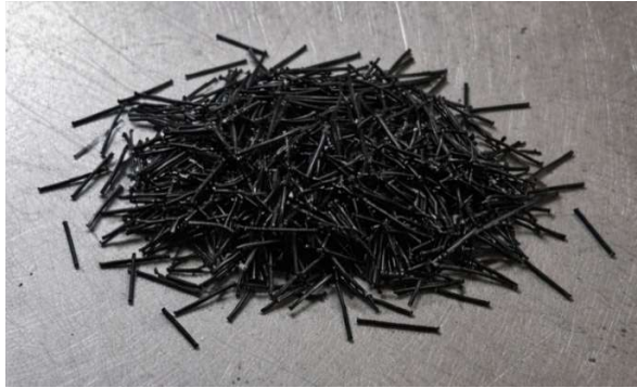
Figura 6-4: fibre omogenee STR 1 - Black lunghe 20 mm
