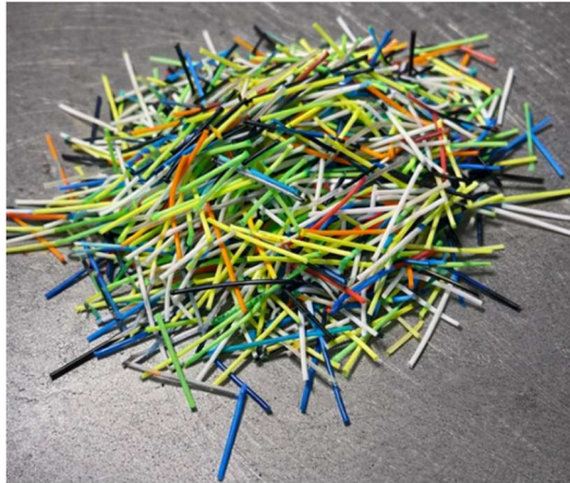
Figura 6-5: fibre eterogenee ricavate da corde miste, lunghezza 30 mm
