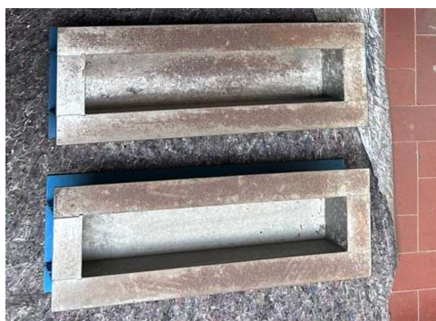
Figura 7-5: casseforme metalliche (100x100x500 mm) utilizzate per la produzione dei campioni prismatici
