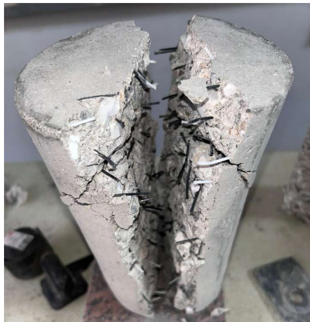
Figura 8-41: vista del campione cilindrico della serie G7-STR20B (1.00) aperto lungo la fessura diametrale
