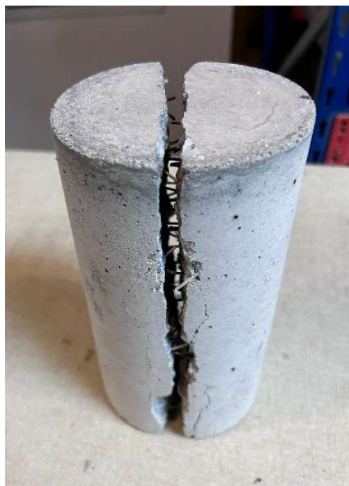
Figura 8-39: vista in sezione delle fibre da 20 millimetri distribuite lungo la fessura diametrale
