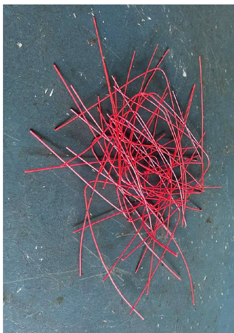
Figure 13-1: operazioni di taglio delle corde riciclate e fibre prodotte
