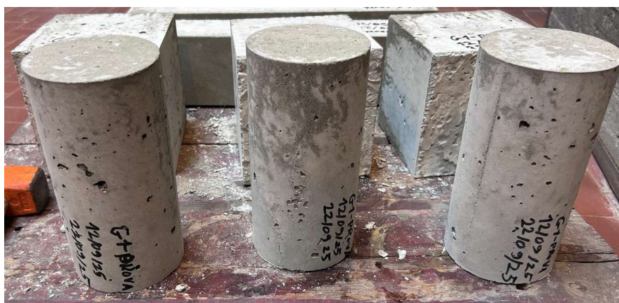
Figura 8-30: Tre provini cilindrici facenti parte della serie con miscela priva di fibre (G1-Nostrings)
