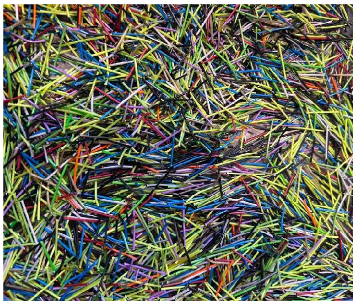
Figura 1-1: corde delle racchette da tennis convertite in fibre di rinforzo.
