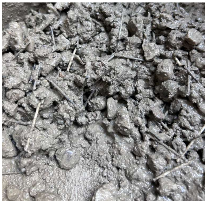
Figura 2-1: Miscela di FRC prodotta in laboratorio: particolare della distribuzione delle fibre sintetiche nella pasta cementizia.
