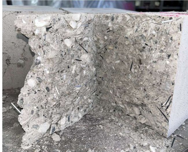
Figura 8-11: vista interna di un campione cubico della serie G5-STR20B (0.25) post rottura per compressione
