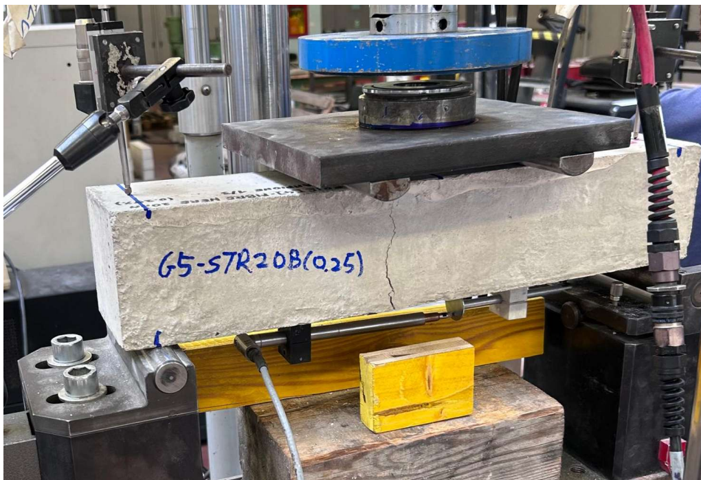
Figura 8-114: prova di flessione su campione rinforzato con fibre lunghe 20 millimetri
