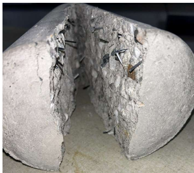
Figura 8-38: vista della sezione di rottura del campione rinforzato con fibre lunghe 20 millimetri
