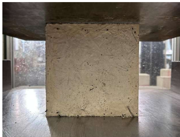
Figura 8-14: fibre visibili sulla faccia del provino cubico sottoposto a test di compressione
