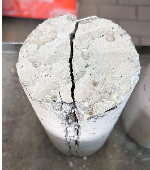
Figura 8-32: campione cilindrico fessurato ma tenuto chiuso dall'effetto di collegamento dovuto alle fibre
