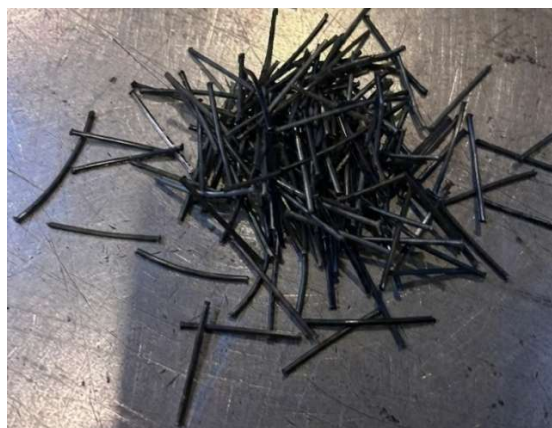
Figura 6-3: fibre omogenee STR 1 – Black lunghe 30 mm
