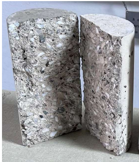
Figura 8-31: cilindro senza fibre diviso in due frammenti in seguito a rottura per prova di trazione indiretta
