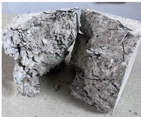
Figura 8-7: vista interna di un campione cubico della serie G3-STR30B (0.50) post rottura per compressione
