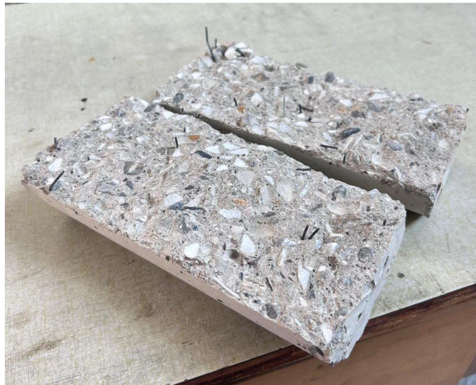
Figura 8-33: distribuzione delle fibre nella sezione di rottura
