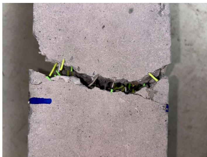
Figura 8-109: fibre miste in azione tra i due piani di fessura generati a flessione
