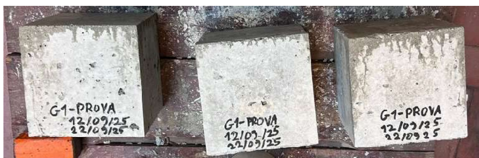
Figura 8-2: Tre provini cubici facenti parte della serie con miscela priva di fibre (G1-Nostrings)
