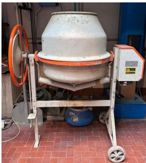
Figura 6-7: betoniera a bicchiere utilizzata per la realizzazione dei getti in laboratorio
