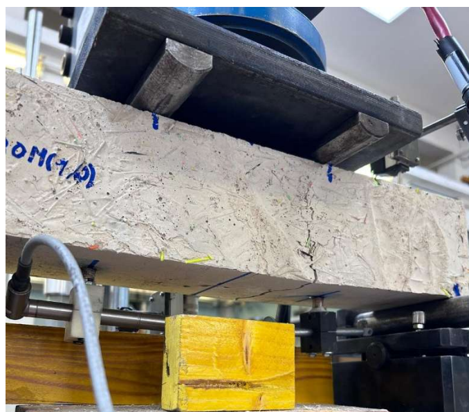
Figura 8-117: test su campione con dosaggio massimo di fibre ottenute da corde miste
