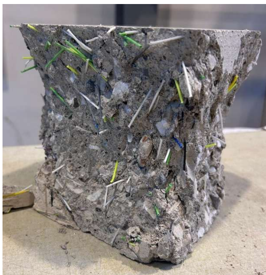
Figura 8-19: vista interna di un campione cubico della serie G9-STR30M (0.50) post rottura per compressione
