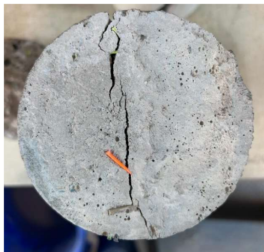
Figura 7-4: provino cilindrico sottoposto a trazione indiretta. Particolare della fessurazione diametrale e delle fibre che si oppongono alla sua apertura
