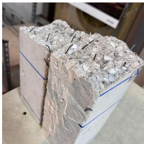
Figura 8-82: distribuzione di fibre in corrispondenza della sezione di rottura di un campione con dosaggio 0.25% di fibre
