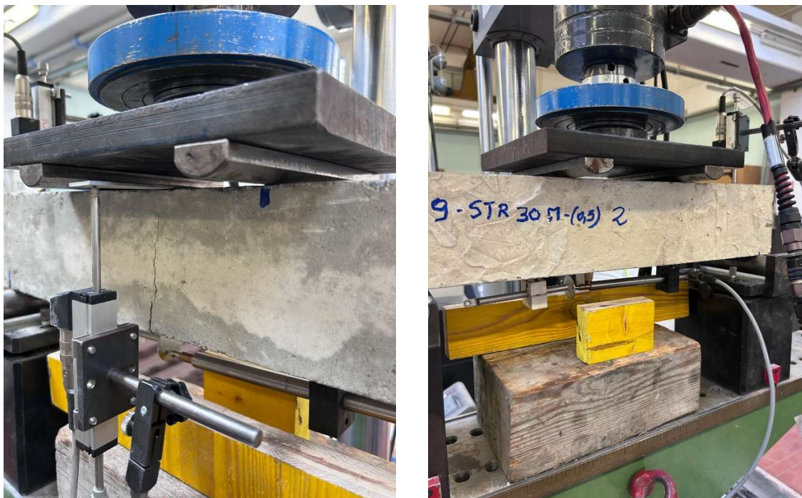
Figura 8-54: particolare del sistema di trasduttori in grado di misurare la freccia in mezzeria e l'allungamento all'intradosso
