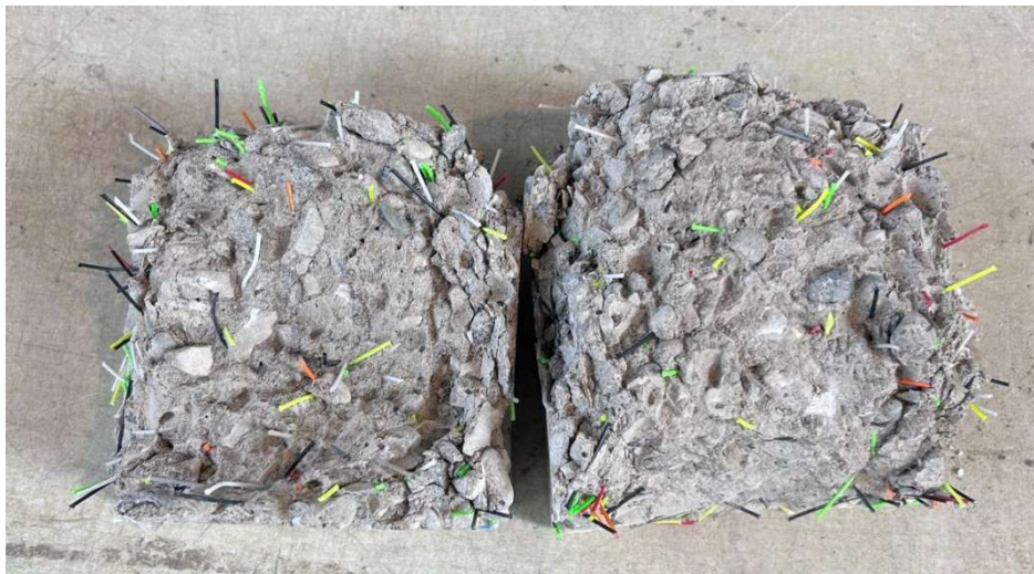
Figura 8-22: cubo aperto per osservare la distribuzione delle fibre miste nella sezione centrale
