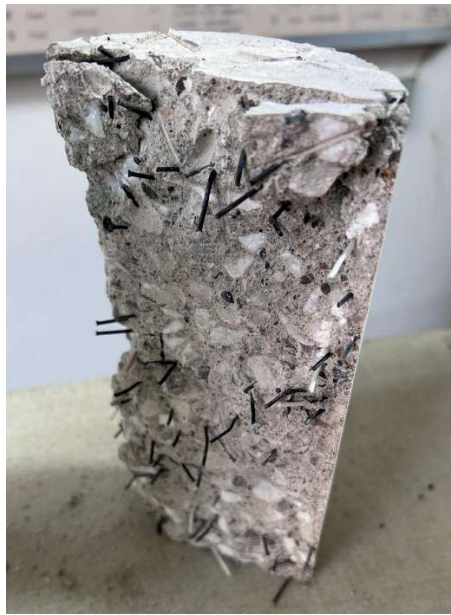
Figura 8-40: distribuzione delle fibre, da 20 mm e in massimo dosaggio, lungo la sezione di rottura
