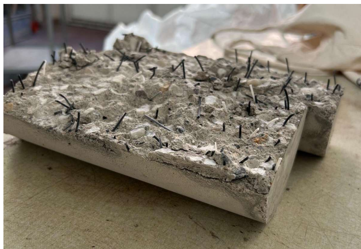
Figura 8-36: vista delle fibre, in situazione di massimo dosaggio, distribuite lungo la sezione di rottura
