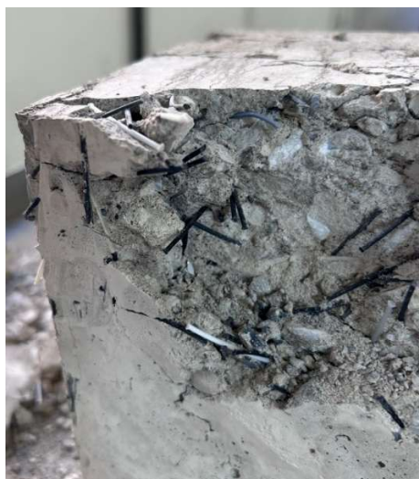
Figura 8-9: vista interna di un campione cubico della serie G4-STR30B (1.00) post rottura per compressione
