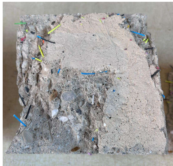
Figure 8-17: fibre miste di diverso colore osservabili internamente ad un campione cubico della serie G8-STR30M (0.25) post rottura per compressione
