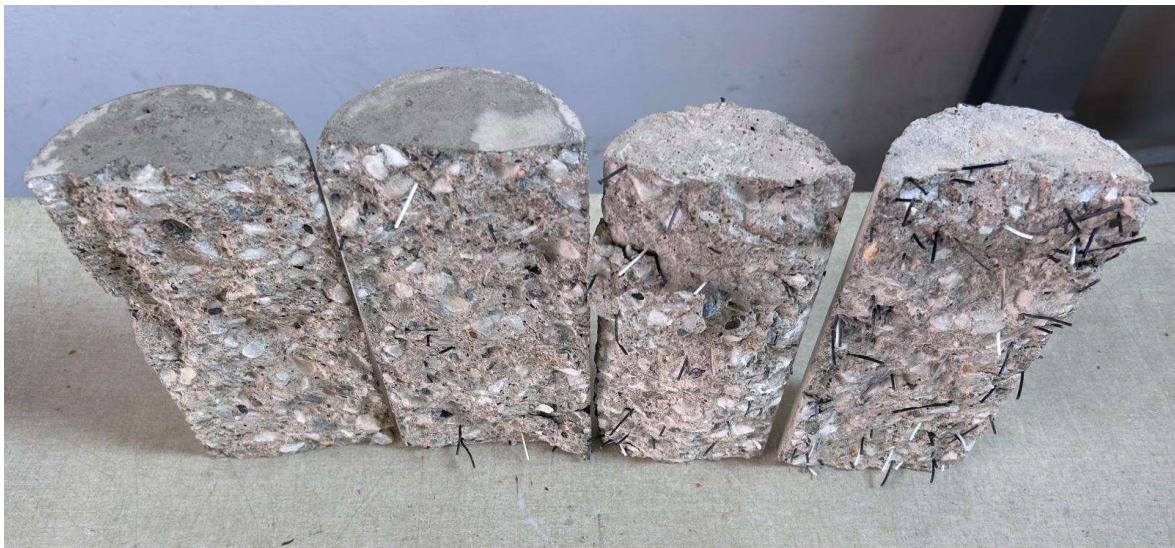
Figura 8-47: confronto interno tra i campioni rinforzati con dosaggi differenti di fibre da 30 mm (da sinistra: fibre assenti, 0.25% in peso, 0.50% in peso, 1.00% in peso)
