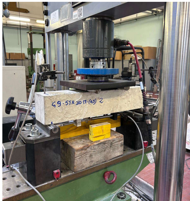
Figura 7-7: vista del sistema di carico e misurazione utilizzato per le prove di flessione
