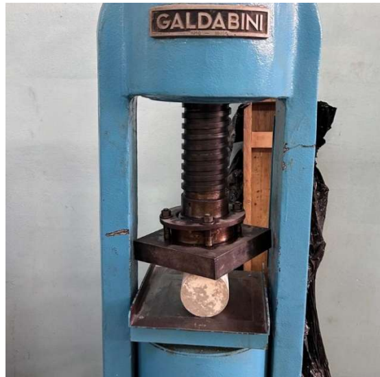
Figura 7-3: test di trazione indiretta su campioni cilindrici eseguito presso il laboratorio MastrLAB
