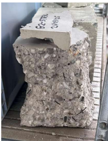
Figura 8-5: vista interna di un campione cubico della serie G2-STR30B (0.25) post rottura per compressione
