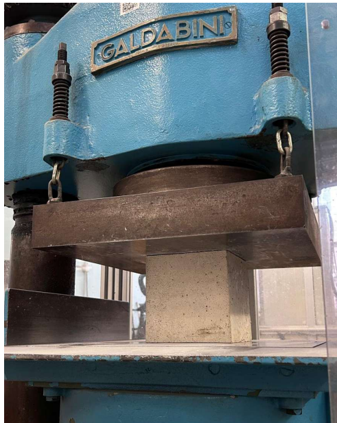
Figura 7-2: test di compressione su campioni cubici eseguito presso il laboratorio MastrLAB
