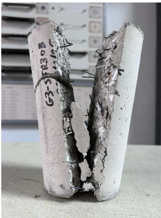
Figura 8-34: campione cilindrico aperto forzatamente. Particolare dei frammenti trattenuti insieme dall'azione delle fibre
