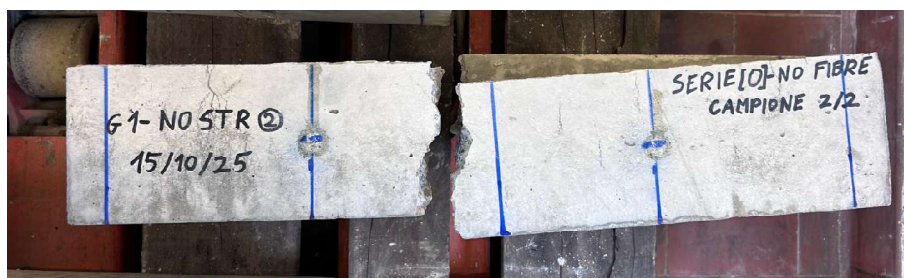
Figura 8-56: campioni privi di fibre portati a rottura per flessione
