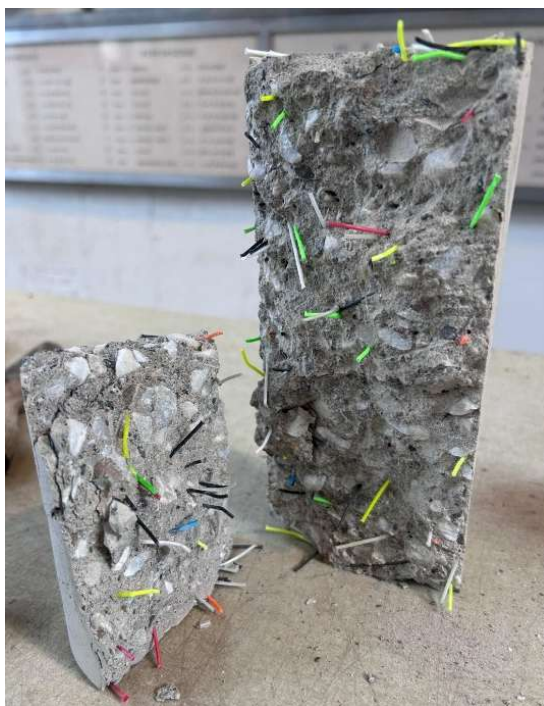
Figura 8-44: dettaglio della dispersione delle fibre miste con massimo dosaggio all'interno del provino cilindrico (aperto post-prova)
