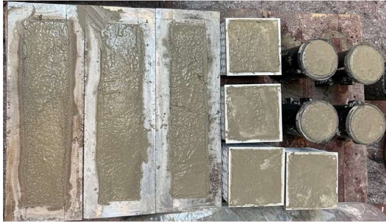
Figura 6-6: quantitativo di calcestruzzo e casseri impiegati per ogni getto
