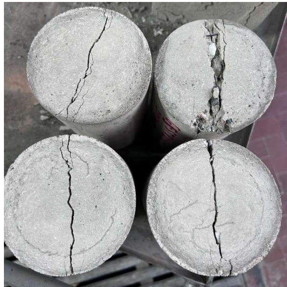
Figura 8-37: campioni della serie G5-STR20B (0.25) fessurati ma tenuti chiusi dall'azione delle fibre
