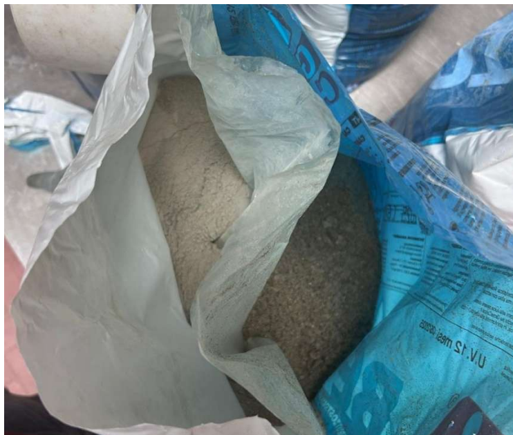
Figura 4-3: vista dei componenti del calcestruzzo predosato contenuti nel sacco di "Betonpiù" suddiviso in due scompartimenti
