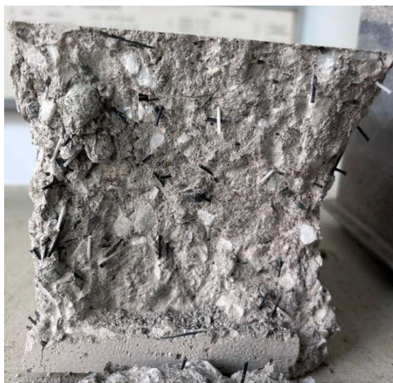
Figura 8-15: vista interna di un campione cubico della serie G7-STR20B (1.00) post rottura per compressione
