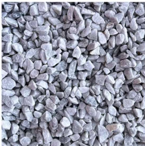
Figura 4-4: granulato di origine naturale con diametro 8\text{ mm} \leq D \leq 12\text{ mm} inserito nel mix design della miscela
