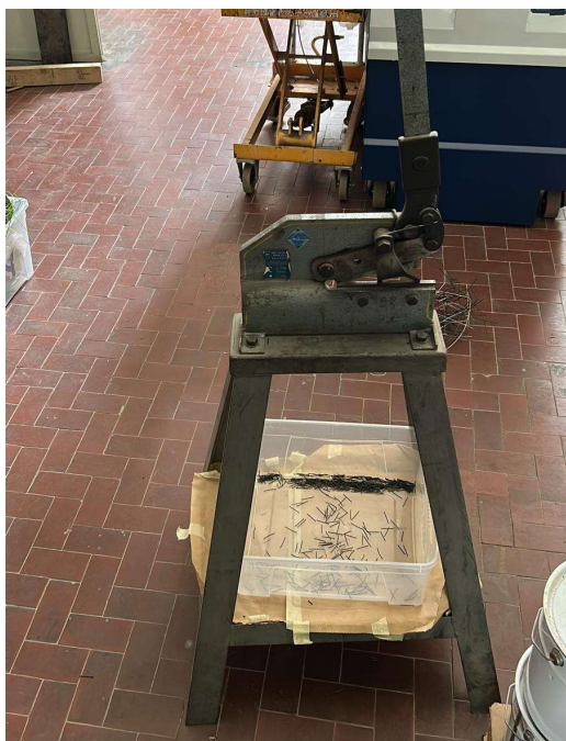
Figure 13-1: operazioni di taglio delle corde riciclate e fibre prodotte
