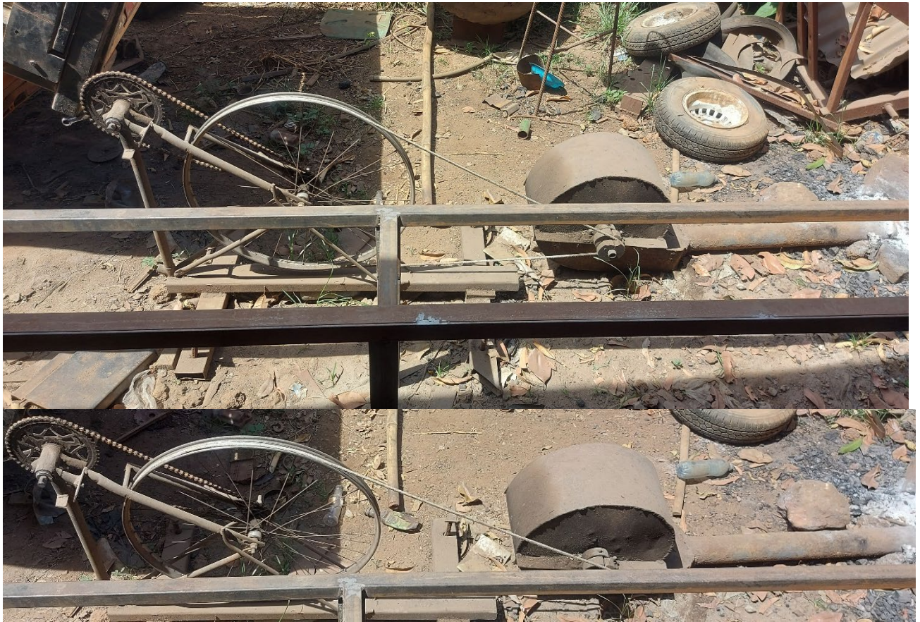
Figura 5.22 sistema di ventilazione per alimentazione fuoco, azionato a pedali
