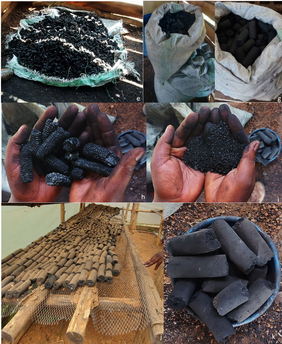
Figura 5.17 Processo fabbrica briquettes: a combustore, b macchinario mescolatore estrusore, c blender, d materiale estruso, e mais core carbonizzati, f materiale carbonizzato, g briquettes stoccati, h mais core, i polvere di raw material, j briquettes in processo essiccazione, k materiale finito
