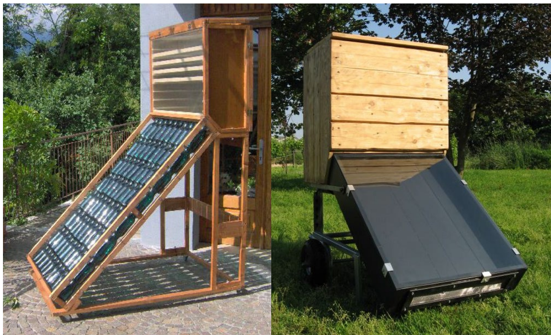
Figura 6.4 esempi di collettore solare (fonte: digilander.libero.it , pepperfriends.com )
