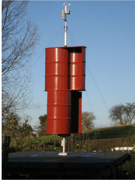
Figura 6.12 Esempio turbina Savonius costruita con sezioni di barile (Fonte: micropowergrids.com)
