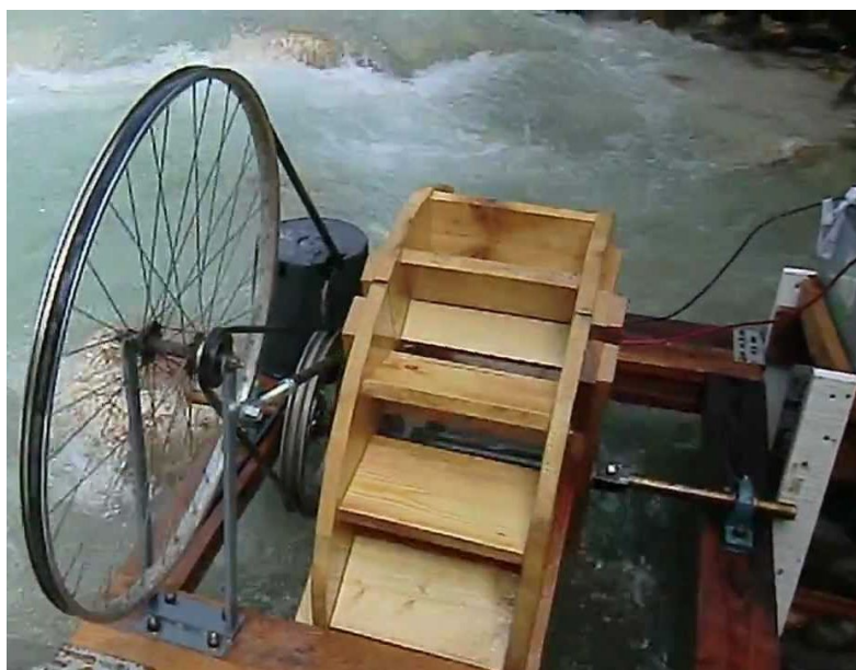
Figura 6.14 esempio micro turbina idraulica autocostruita (fonte: yting.com)
