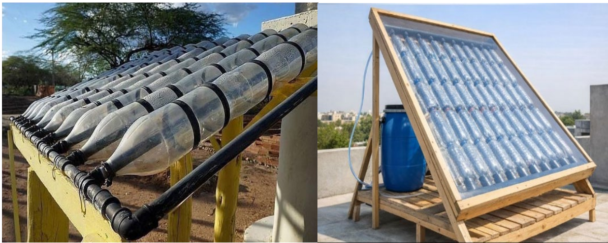
Figura 6.9 esempi collettori solari realizzati con bottiglie di plastica riciclate (fonte: preview.redd.it)
