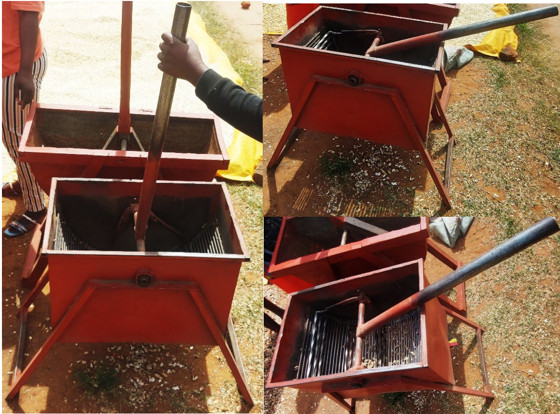
Figura 5.30 Tecnologia a vasche per sgusciare le noccioline
