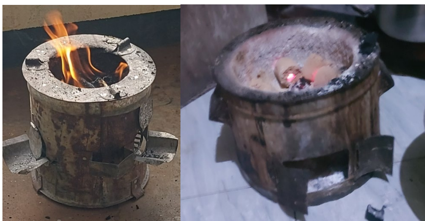
Figura 5.15 cucina cilindrica per charcoal con strato di isolante interno
