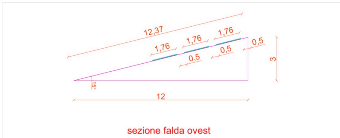
Figura 35: Sezione falda ovest con quotatura (m)
