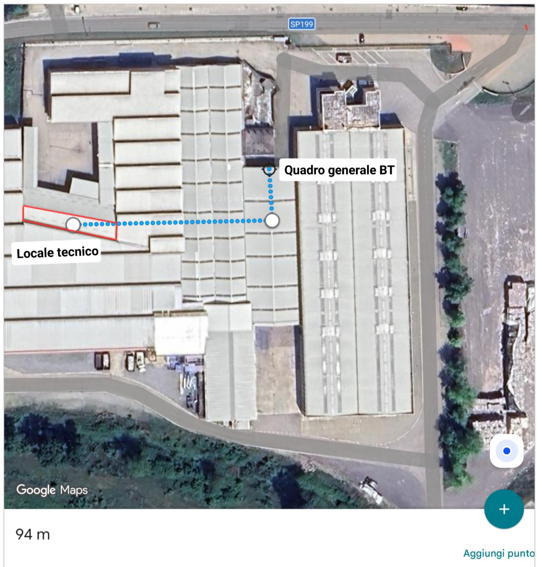
Figura 63: Stima della lunghezza della linea tra quadro di parallelo e quadro generale BT.
