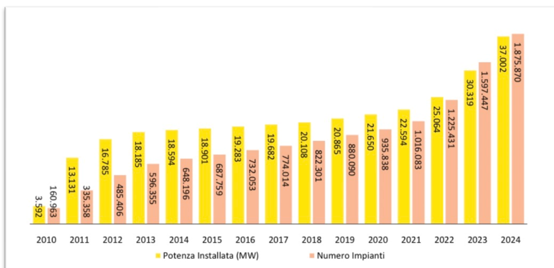
Figura 2: Evoluzione della potenza fotovoltaica installata e del numero di impianti in Italia
