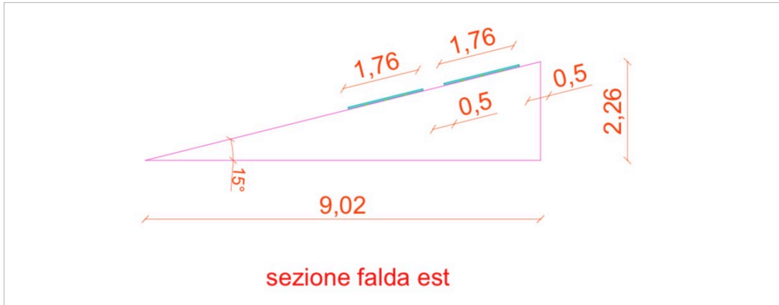
Figura 38: Sezione falda est con quotatura (m)
