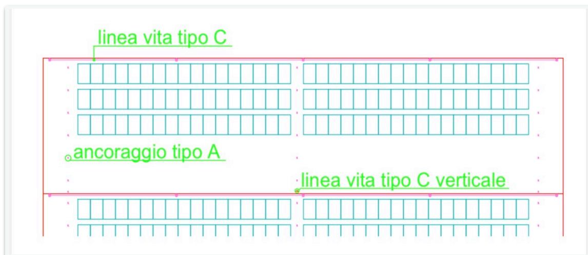
Figura 44: Pianta linee vita installate in ciascuna falda
