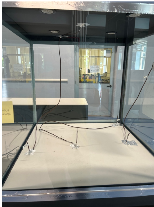
Figura 8-set up sperimentale per le misure della temperatura
