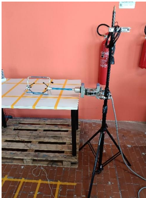
Figura 8: anemometro ad ultrasuoni per la misura della velocità dell'aria
