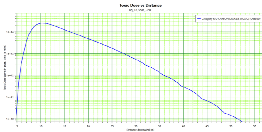
Figura 59 - Dose tossica in funzione della distanza per modello PHAST rilascio liquido
