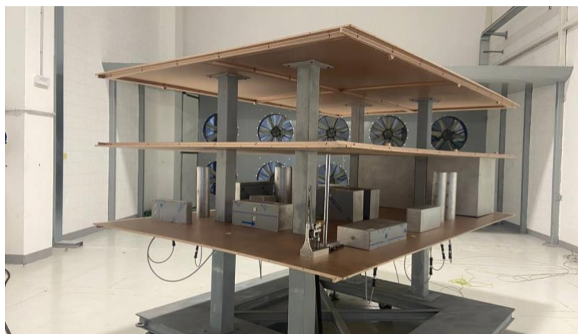
Figura 10 - Mock-up del modello 1:10 in galleria del vento
