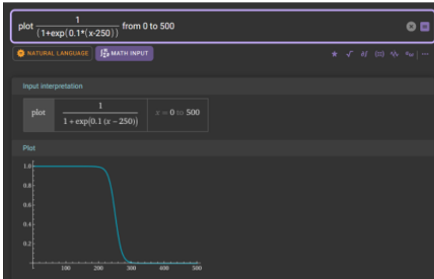
Figura 7.8. Funzione sigmoideale utilizzata da CitySim per regolare i dispositivi di schermatura. [41]
