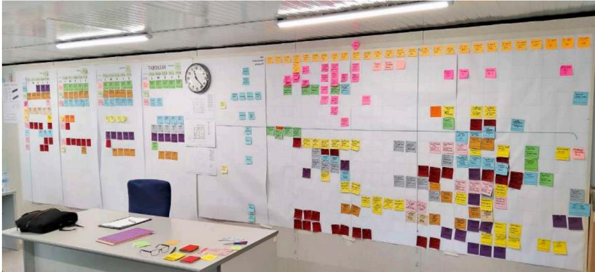
Figura 17-Esempio di pianificazione a medio-breve termine LPS (Clúster de la Edificación, 2022)
