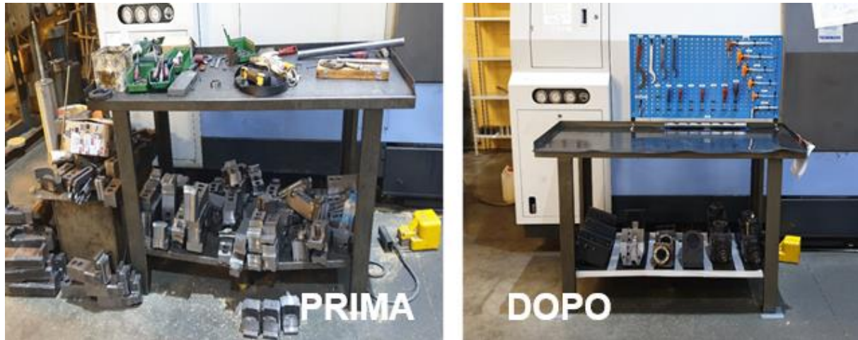
Figura 22-Esempio di applicazione del metodo 5S: confronto tra postazione di lavoro prima e dopo (CTQ, 2019)
