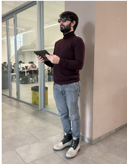
Figura 4.2: Setup hardware completo indossato dall'utente: Project Aria Gen1 per l'acquisizione visiva e spaziale, e Tablet per il feedback e l'elaborazione lato client
