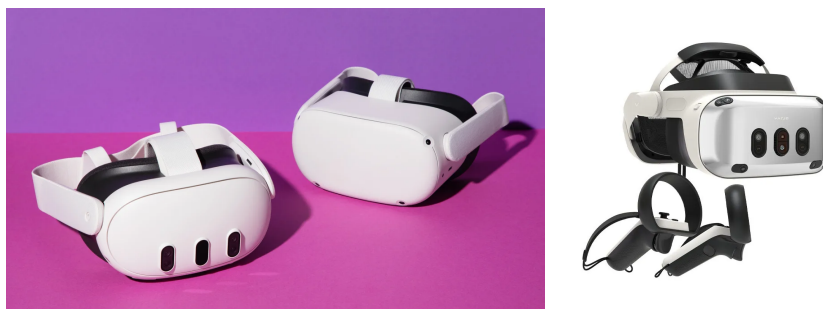
Figura 3.1: Meta Quest 2/3 e Varjo XR-4: Visori di realtà virtuale utilizzati come dispositivi di visualizzazione immersiva di riferimento durante lo sviluppo e i test dell'interfaccia VR del software.
