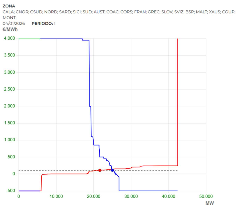
Figura 4: Grafico domanda-offerta del mercato MGP per una zona del mercato italiano, per una determinata ora 11 . Fonte: GME.
