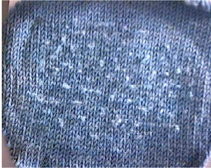
Figura 19 (tondino di un tessuto sottoposto a 2000 cicli del test - fonte lartessile.it)
