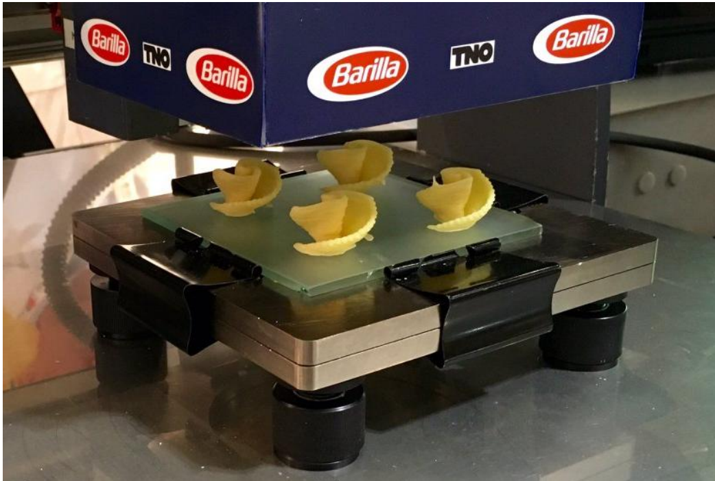
Figura 7: stampante 3D impiegata nella produzione della pasta Barilla [19]
