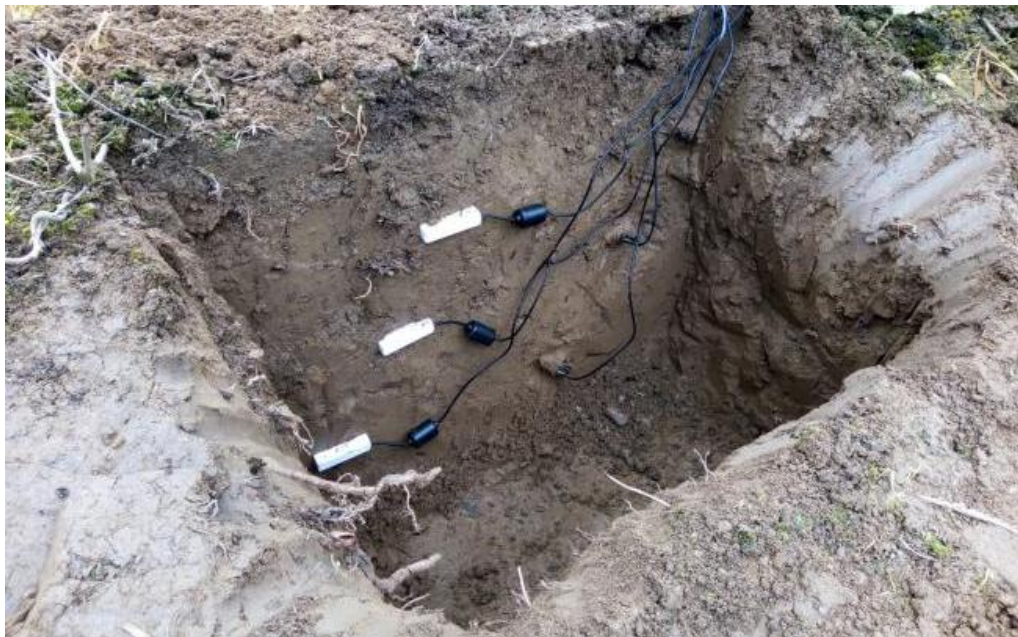
Figura 24: collocazione dei sensori nel terreno [72]
