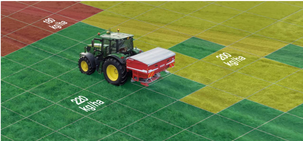
Figura 23: Processo di concimazione con dosaggio a rateo variabile tre misure differenti [67]
