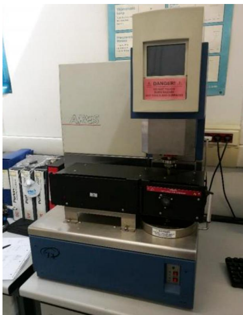
Figura 42 - Reometro rotazionale a piatti paralleli ARES
