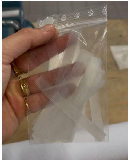
Figura 29 - Provini rettangolari di film di LDPE di dimensione 90×10 mm realizzati mediante fustellatrice pneumatica AMSE
