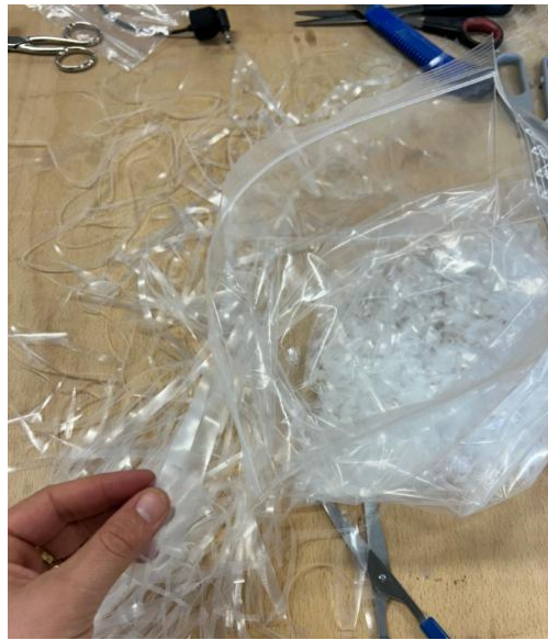
Figura 11 - Frammenti di film di LDPE vergine irraggiato per un tempo di 128 h
