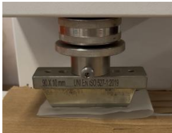
Figura 30 – Fustella rettangolare con cui sono stati realizzati i provini rettangolari di film di LDPE aventi dimensioni 90×10 mm
