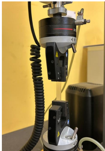
Figura 39 - Morsetti pneumatici a ganasce laterali del dinamometro modello 5966 Instron
