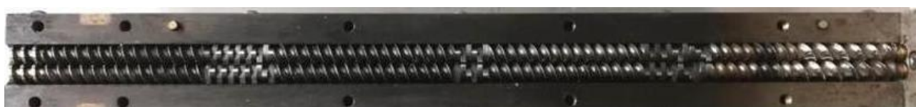
Figura 17 - Viti co-rotanti appartenenti all'estrusore Process 11 di Thermo Fisher Scientific
