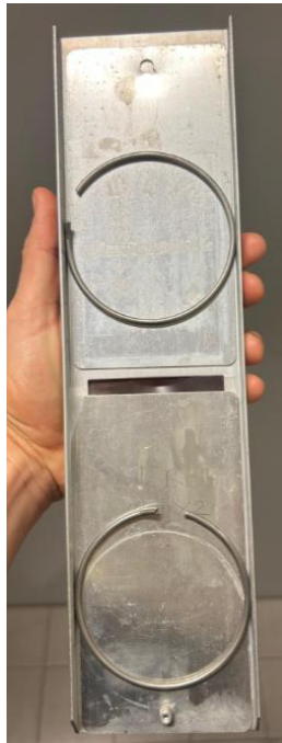
Figura 41 - Vista posteriore del porta-campioni contenente i campioni di LDPE riciclato con lo 0.5wt% di Irganox 1010 che subiranno test di trazione al dinamometro modello 5966 Instron
