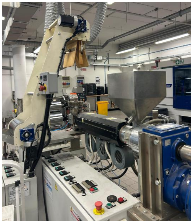
Figura 7 - Estrusore di film in bolla prodotto da EUR.EX.MA, lato testa di estrusione
