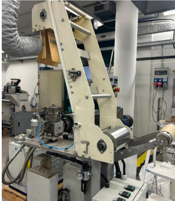
Figura 8 - Estrusore di film in bolla prodotto da EUR.EX.MA, lato sistema di traino
