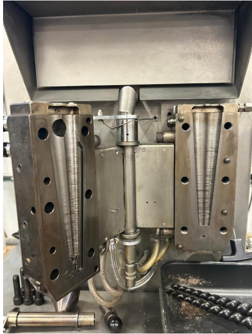
Figura 19 - Vista interna del mini-estrusore Xplore MC 15
