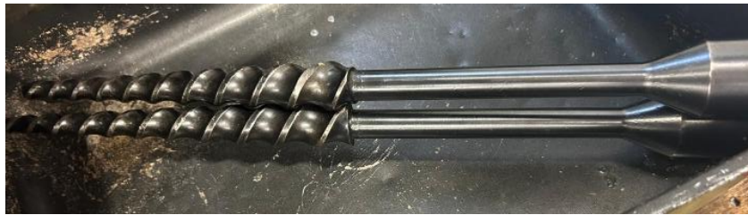
Figura 20 - Viti del mini-estrusore Xplore MC 15
