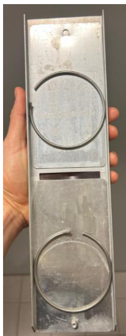
Figura 37 - Vista posteriore della disposizione dei campioni di film di LDPE collocati nel porta-campioni da inserire nel QUV tester
