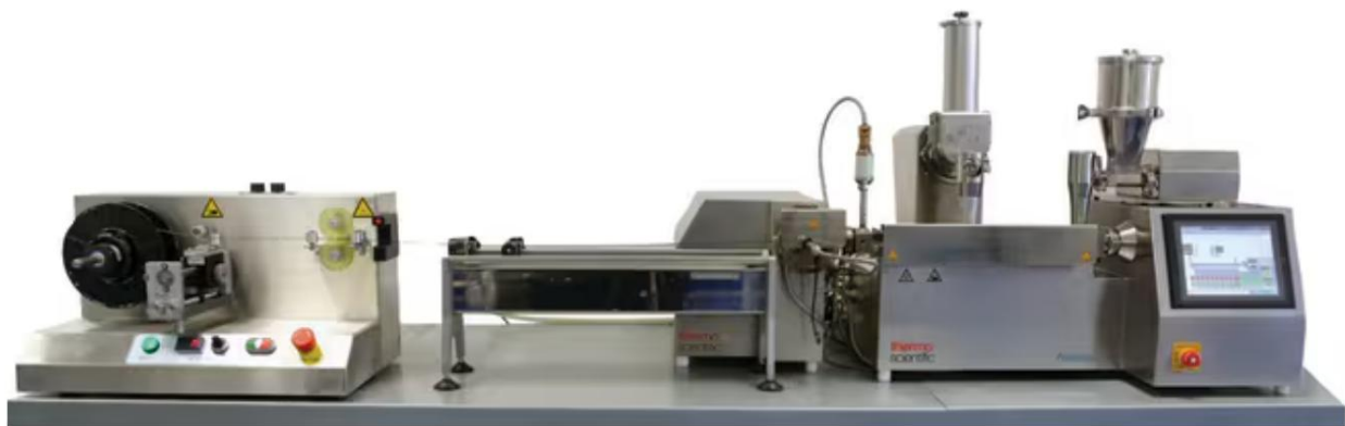
Figura 12 - Estrusore bivate co-rotante Process 11 di Thermo Fisher Scientific [12]
