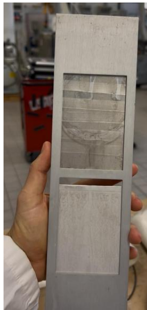
Figura 40 – Vista frontale del porta-campioni contenente i campioni di LDPE riciclato con lo 0.5wt% di Irganox 1010 che subiranno test di trazione al dinamometro modello 5966 Instron
