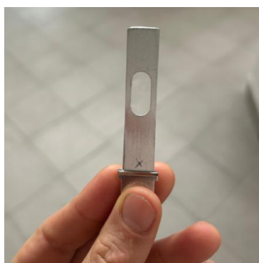
Figura 32 – Porta-campione metallico per l'analisi di una porzione di film allo spettrometro FTIR-ATR
