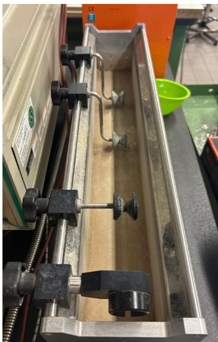
Figura 13 - Vasca d'acqua situata all'uscita dell'ugello dell'estrusore bivate co-rotante
