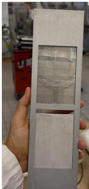
Figura 36 - Vista frontale della disposizione dei campioni di film di LDPE collocati nel porta-campioni da inserire nel QUV tester
