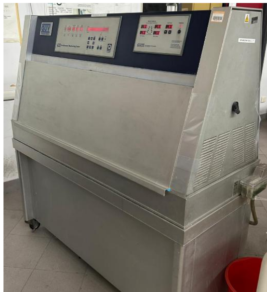
Figura 23 - QUV tester utilizzato per il presente lavoro di tesi
