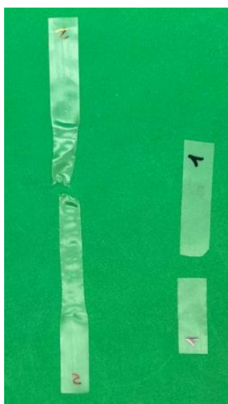
Figura 62 – Provini di rLDPE + 0.5wt% Irganox 1010 sottoposti a test di trazione fino a giungere a rottura. Il campione irraggiato 0 h è contrassegnato dal numero 2 mentre il campione irraggiato 240 h è contrassegnato dal numero 1.
