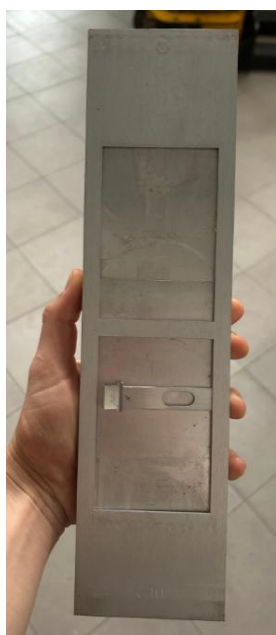
Figura 34 - Porta-campioni metallico per l'invecchiamento di una porzione di film destinata all'analisi allo spettrometro FTIR-ATR
