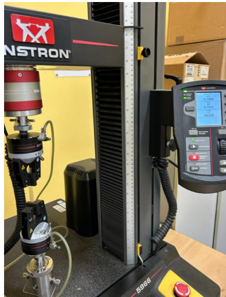
Figura 38 - Dinamometro modello 5966 Instron
