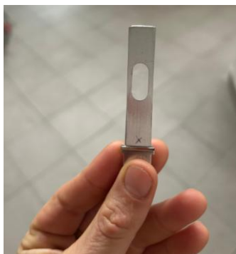
Figura 33 - Porta-campione metallico per l'analisi di una porzione di film allo spettrometro FTIR-ATR
