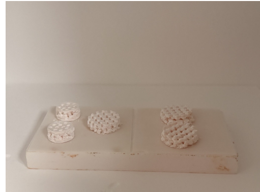
(b) Giroidi dopo il ciclo di debinding in forno.
