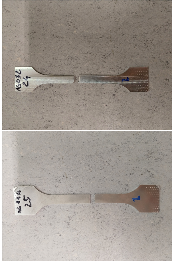
Figura 6.3: Modalità di rottura dei provini AG052 24_2 e AG144 25_2
