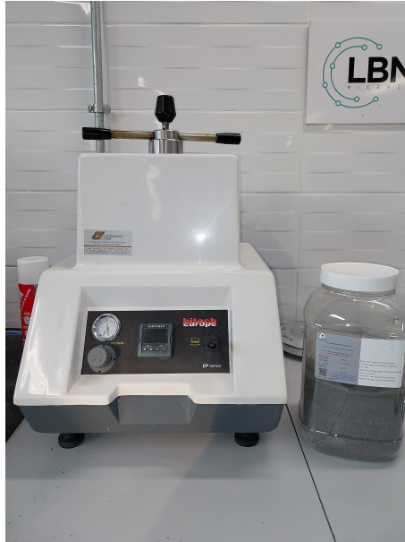
Figura 5.3: Inglobatrice Hitech europe EP series e resina termoindurente utilizzata
