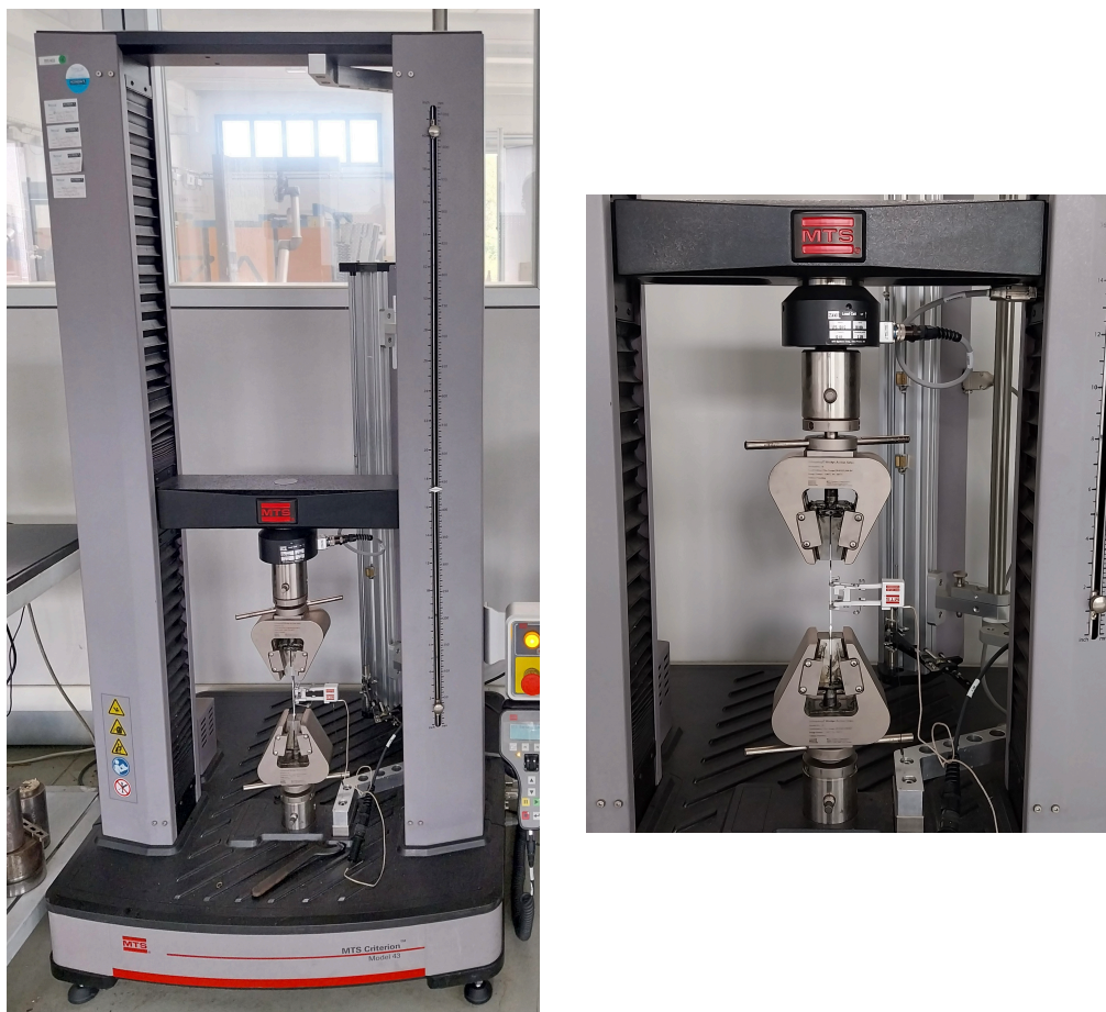
Figura 5.6: Macchina di trazione MTS Criterion Model 43 e focus su estensimetro
