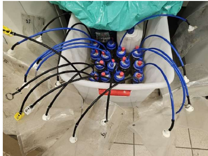
Figura 9 - Vasca d'incubazione mesofila
