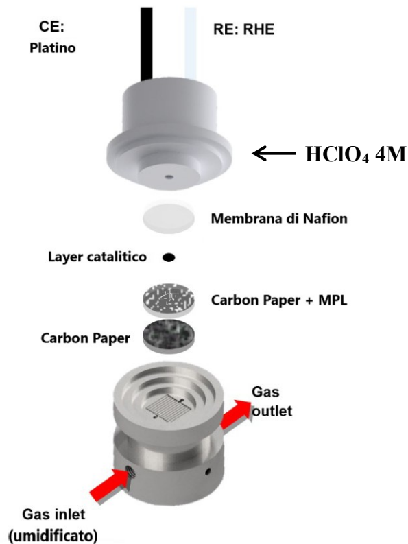
Figura 5.26: Configurazione della cella GDE [85].
