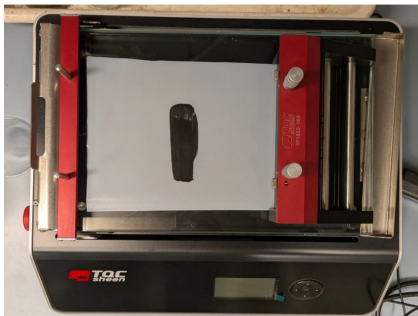
Figura 5.28: Stesura del film catalitico Pt/C/MnO x su PTFE mediante TQC Sheen “Adjustable Micrometer Applicators”.
