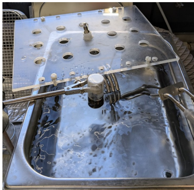
Figura 5.9: In basso, sonicatura dell’inchiostro catalitico; in alto sonicatura dell’elettrodo.
