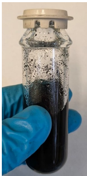
Figura 4.27: Vial di vetro per la sintesi idrotermale assistita da microonde.
