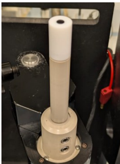
Figura 5.13: Essiccazione rotante dell'inchiostro catalitico su elettrodo di lavoro.
