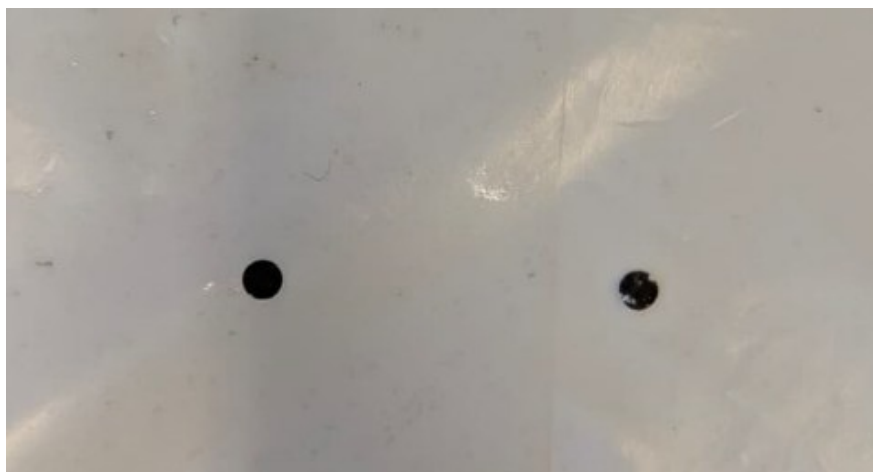
Figura 5.31: Trasferimento incompleto del materiale catalitico Pt/C/MnO x sulla membrana.
