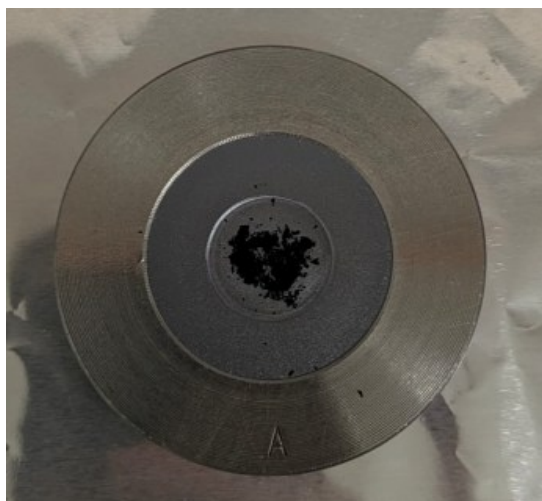
Figura 3.9: Corpo metallico circolare e portacampione di silice. Al centro il catalizzatore da analizzare.
