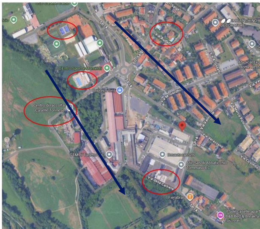
Figura 4.9 – Caselle Torinese (TO) – 106310001 (acquifero superficiale). Il pozzo (segnaposto in rosso) è adiacente ad aziende per la produzione della carta e a un centro di raccolta. Si segnala anche la presenza di piscine pubbliche e private in direzione del flusso (Fonte: Google Maps). Le frecce indicano indicativamente la direzione del flusso sotterraneo.
