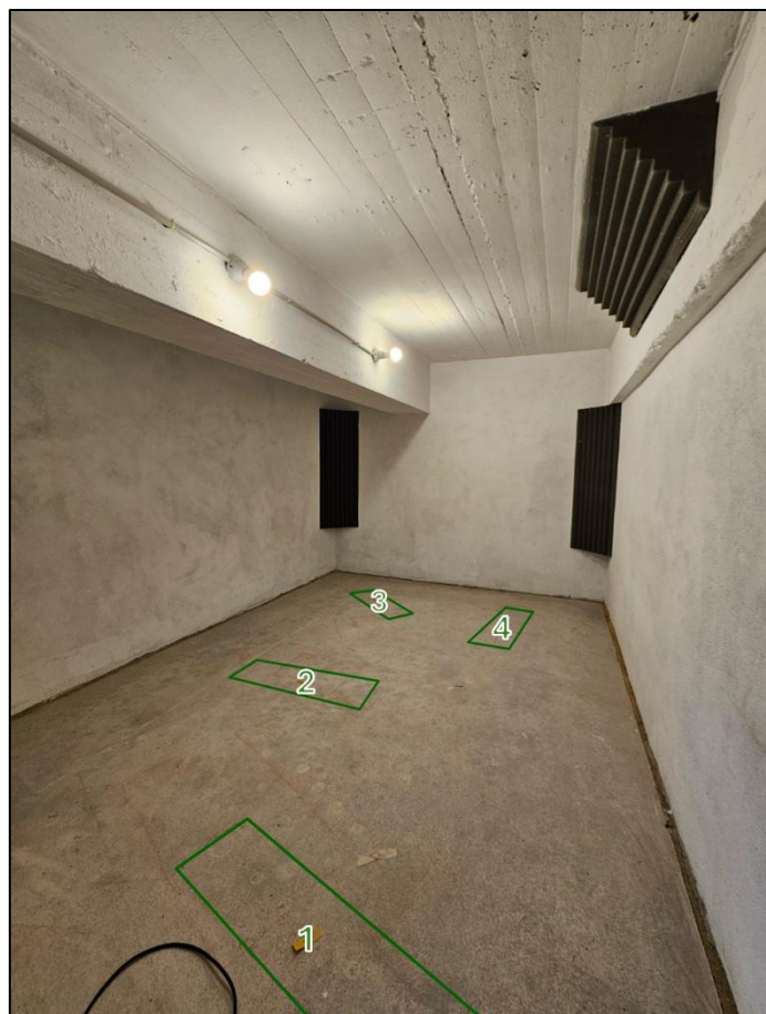
Figura 19 - Disposizione e numerazione delle quattro posizioni della macchina per impatti utilizzate nelle prove. Elaborazione propria.
