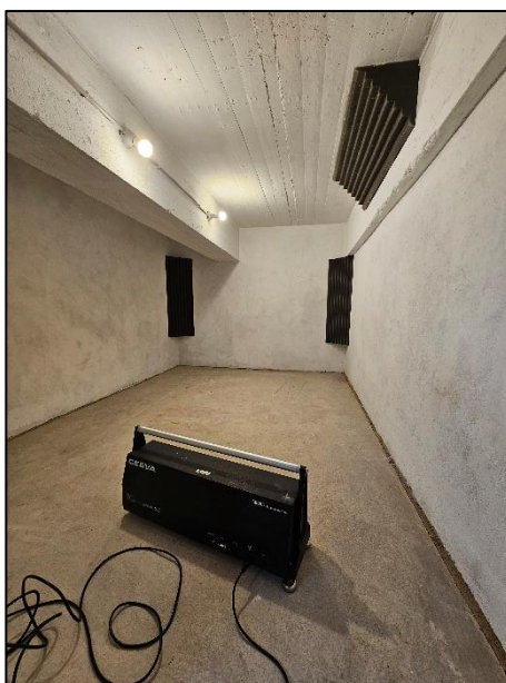
Figura 21 – Macchina per impatti sul solaio grezzo
