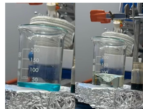
Figura 24 Campione Cu5%-MOF, soluzione con acetato di rame prima e dopo l'inserimento del modulatore
