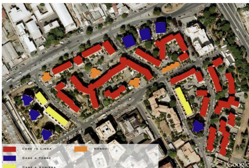
Figura 1.9: conformazione edilizia del quartiere Tiburtino (Roma).
