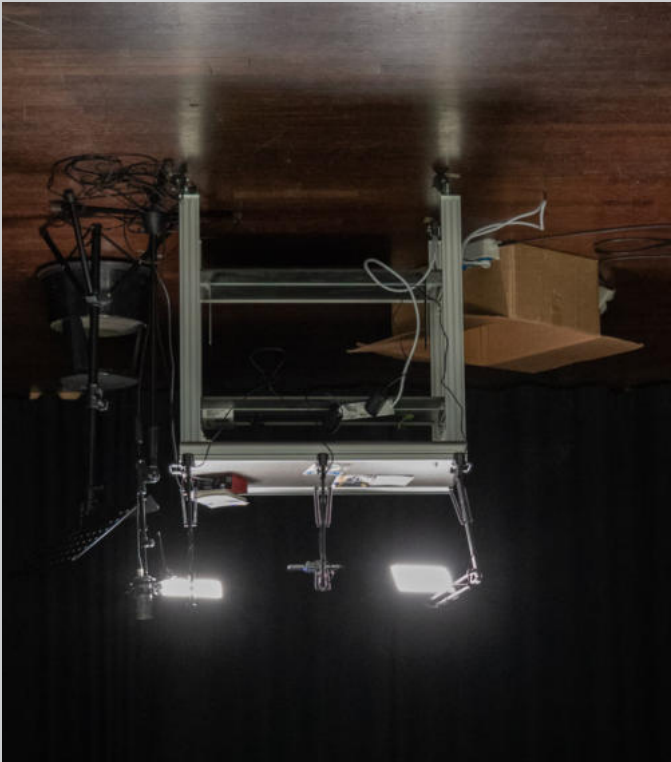
Set di ripresa per digitalizzazione di libri (studio, luci e camera su stativo) Lanari M., van Bladel R., Archival Consciousness. Biblio-Graph, Mobile Archive Unit, 2020.
