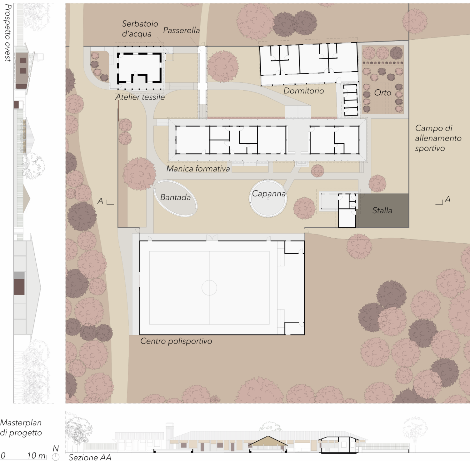
Fig. 5.8 - Masterplan di progetto: planimetria, prospetto e sezione. Fuori scala. Livello di definizione grafico 1:200 (realizzazione dell'autore).
