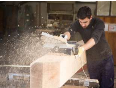
Figura [12] Esempio di piallatura manuale con pialla elettrica.
