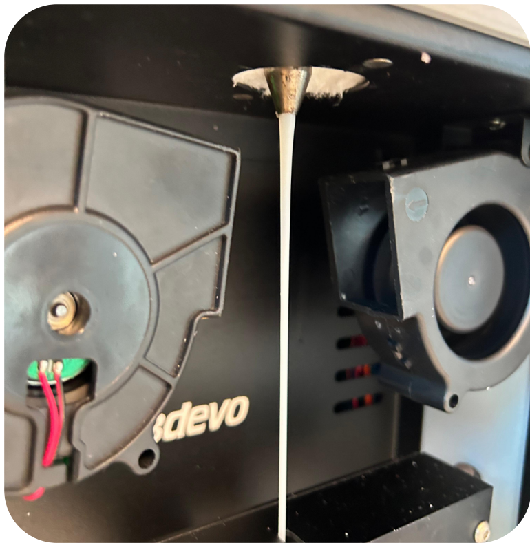
Figura 7. Fase di trasformazione dei pellet in filamento tramite estrusione
