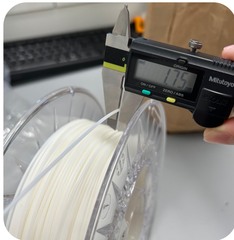
Figura 8. Bobina di filamento in ABS ottenuta tramite processo di estrusione
