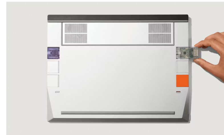
Porte modulari estraibili del Framework Laptop 16.
