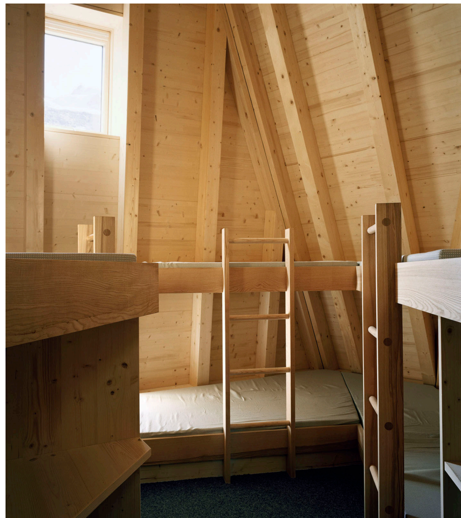
fig 64: letti a castello trapezoidali e poligonali, in frassino massello con anima bruna e pannelli a tre strati in abete e larice non trattati, Monte Rosa Hütte, Svizzera
