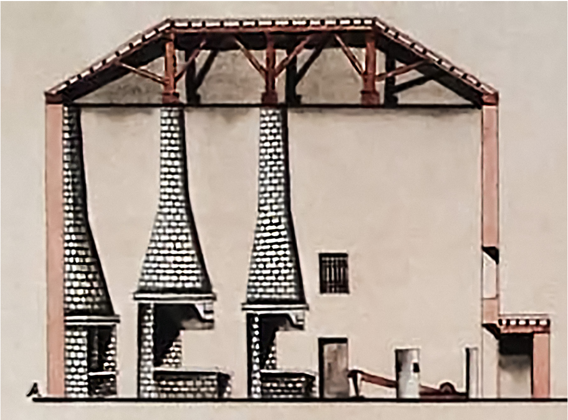
Sezione della fucina nuova della famiglia Signorelli di Cuorné. Marco Cima, “Archeologia del rame, Il caso del Canavese Estrazione, metallurgia e sistemi produttivi”, Nautilus, Torino, 2025 p.21
