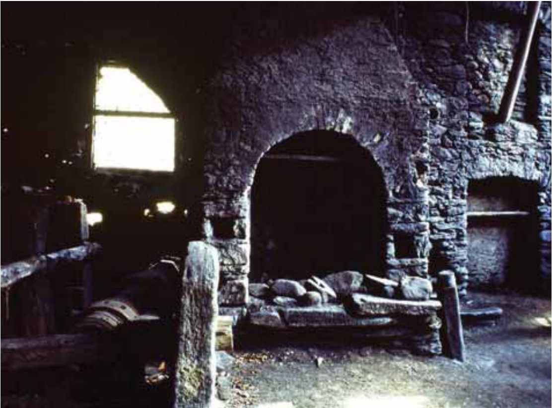
La forgia piccola e a sinistra la seconda batteria di magli. Marco Cima, “Archeologia del rame, Il caso del Canavese Estrazione, metallurgia e sistemi produttivi”, Nautilus, Torino, 2025 p.97
