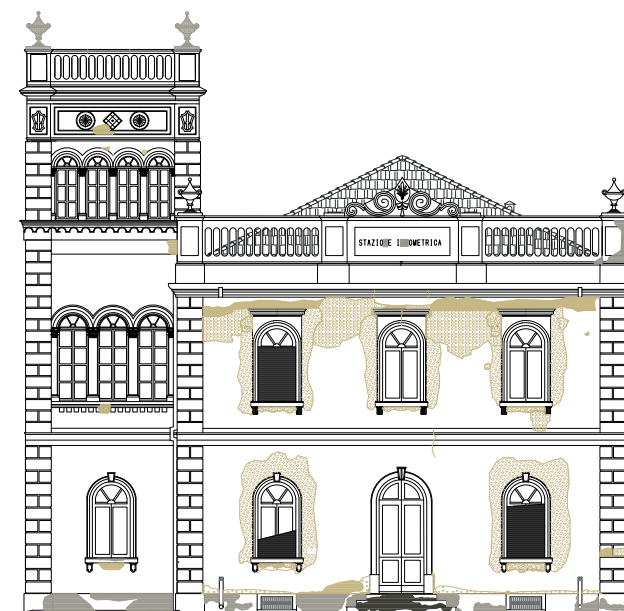
24 | In alto: Prospetto sud, analisi dei degradi 25 | In basso: Prospetto nord, analisi dei degradi
